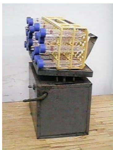
FIGURA 3.4 IMAGEM DA MESA AGITADORA E DO CORPOS DE PROVA EM DETALHE.
