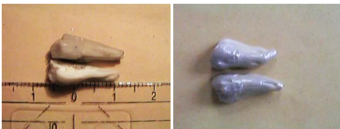
FIGURA 3.2 - ESPÉCIMES SECCIONADOS (ESQUERDA) E METALIZADOS (DIREITA) PARA O ESTUDO DE INCORPORAÇÃO DE ÍONS FLUORETO POR MEV-EDS.
