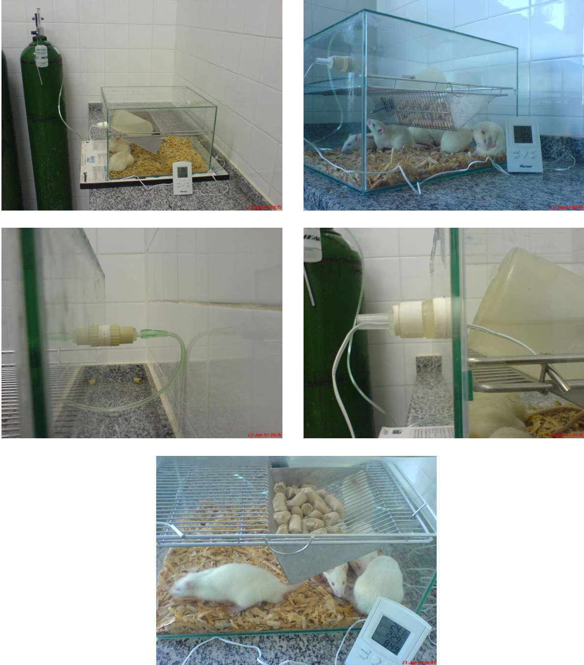
Figura 3. Estrutura para produção de ambiente de hiperóxia com cilindro de oxigênio com capacidade para 10 m 3 (10000 litros), umidificador de passagem. Conexão com caixa de vidro por meio de interface com 1 cm de diâmetro. Orifício de saída de ar e cabo de termômetro digital. Manutenção da oferta de ração e água durante período de exposição à hiperóxia.
