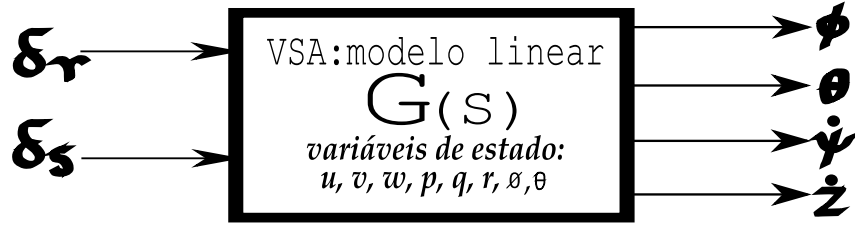
Figura 5.5: Modelo Linear Invariante no Tempo do Veículo Submersível Autônomo, .
