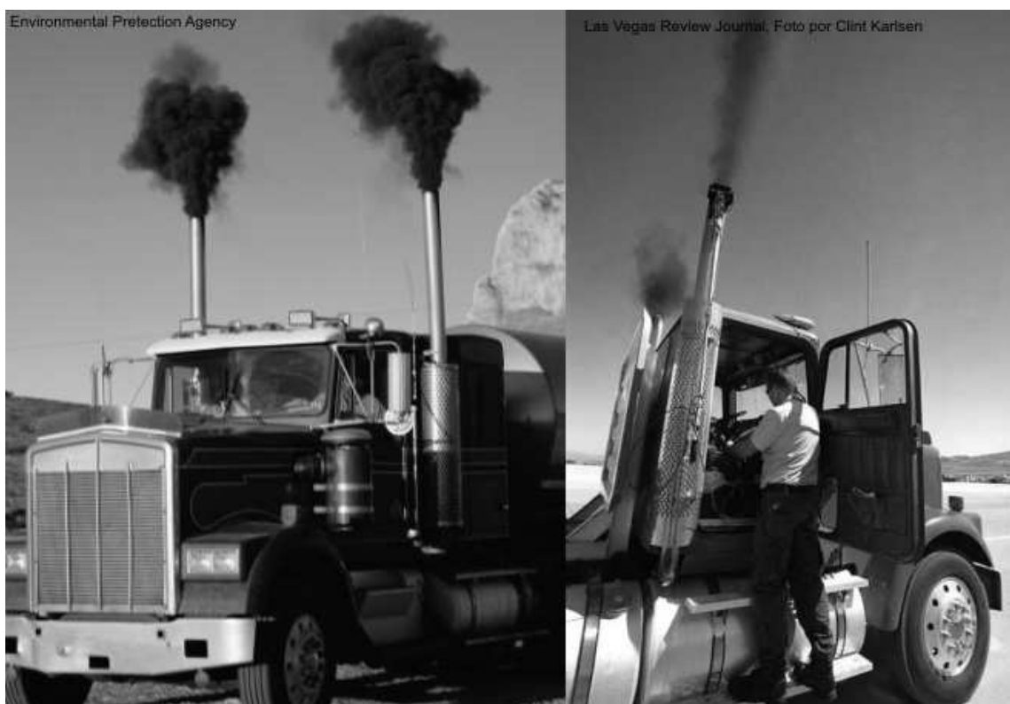
Figura 1.1: Fumaça de exaustão de Caminhões Diesel.
