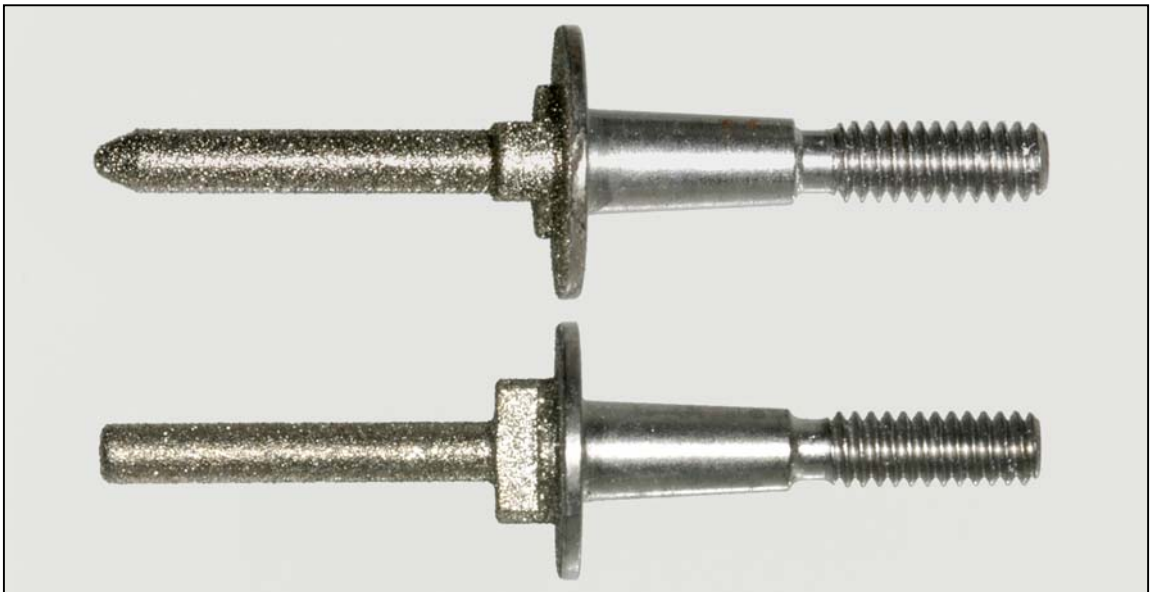
Figura 34: Pontas diamantadas empregadas na usinagem das restaurações. A substituição das mesmas foi realizada sempre que solicitada pelo software.
