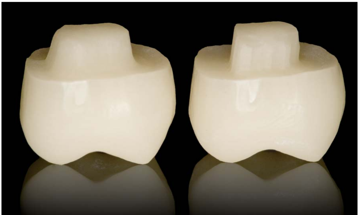
Figura 37: As restaurações acima, referentes ao mesmo dente, foram fabricadas durante a fase piloto do estudo. A única variação de uma restauração para outra foi o modo de usinagem. Na restauração da direita, usinada em modo PADRÃO, é evidente o menor volume de cerâmica na região correspondente à câmara pulpar. Na restauração da esquerda, usinada em modo ENDO, a mesma região reproduz corretamente o contorno do preparo.
