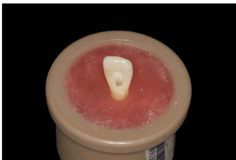
Figura 17 - Inclusão dos dentes em cilindros de PVC com cera utilidade.
