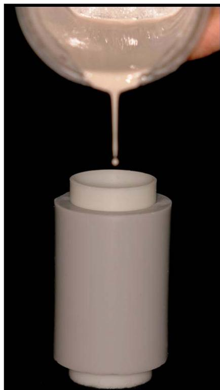
Figura 44 - Revestimento sendo cuidadosamente despejado no interior do cilindro
