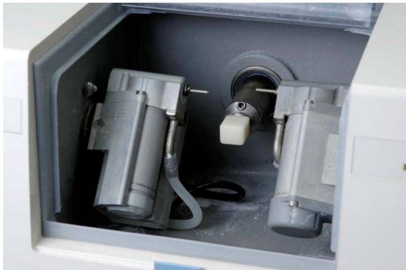
Figura 55 - Em maior aumento, o bloco cerâmico devidamente posicionado na máquina fresadora, previamente a realização do desgaste
