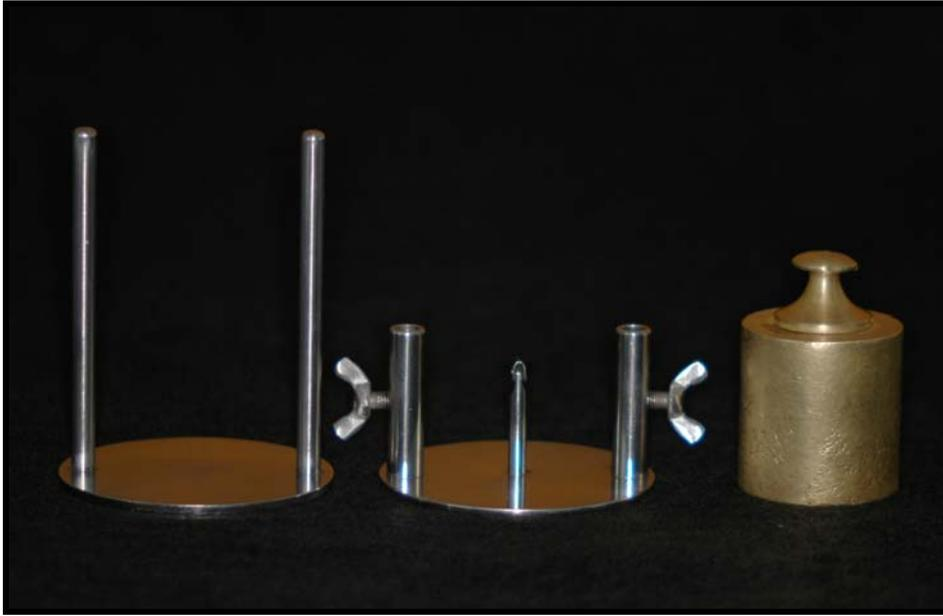
Figura 56 - Dispositivo metálico, base fixa e base móvel, e peso de 500g
