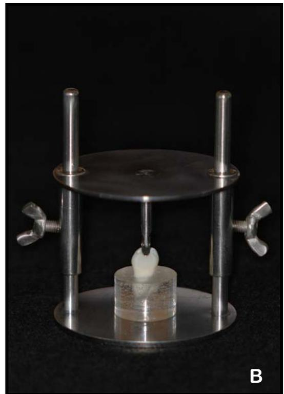
Figura 57 - Conjunto dente/peça cerâmica posicionado no centro da base fixa do dispositivo, antes (A) e após o posicionamento da base móvel (B)
