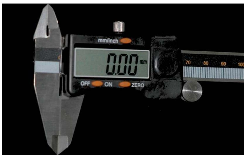
Figura 9 - Paquímetro eletrônico digital Digimess 100.174 BL (Digimess Instrumentos de Precisão Ltda., China)
