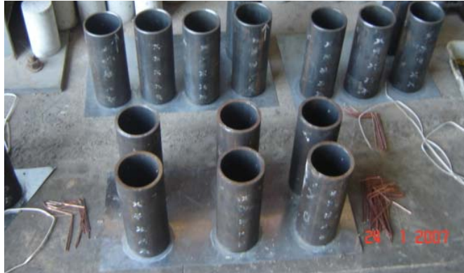
Figura 30 - Tubos posicionados para concretagem
