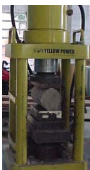
Figura 109 - Esquema do ensaio de tração por compressão diametral
