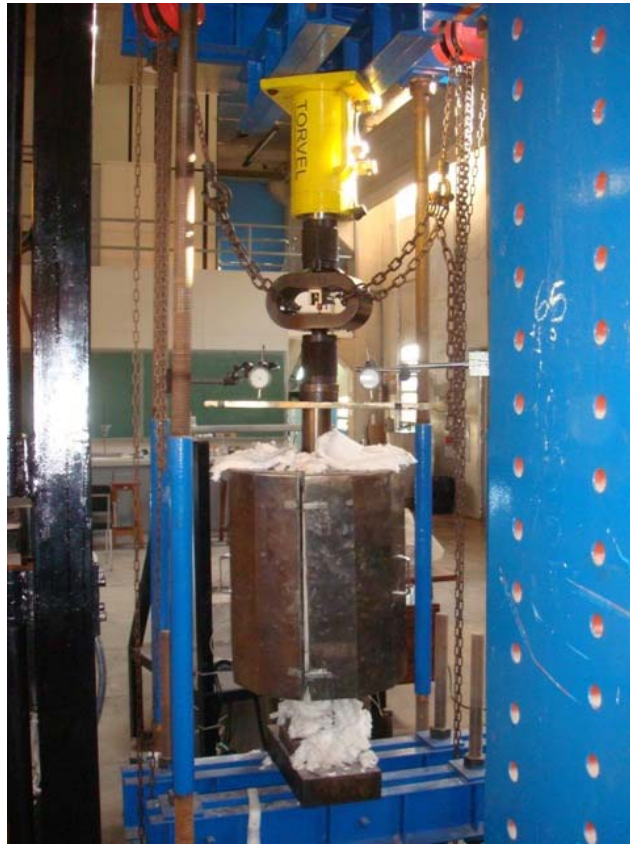
Figura 35 - Sistema de ensaio de carregamento em alta temperatura
