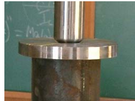
Figura 24 - Haste e flange para aplicação de carga
