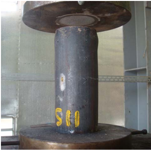
Figura 46 - Pilar misto deformado
