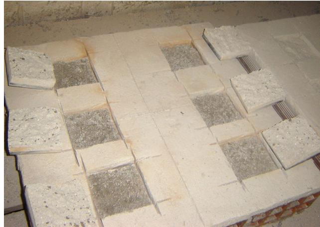
Figura 4.28 Forma de ruptura da argamassa no ensaio de aderência.
