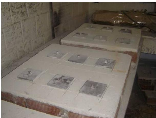
Figura 3.8 Painel com as placas para ensaio de aderência.
