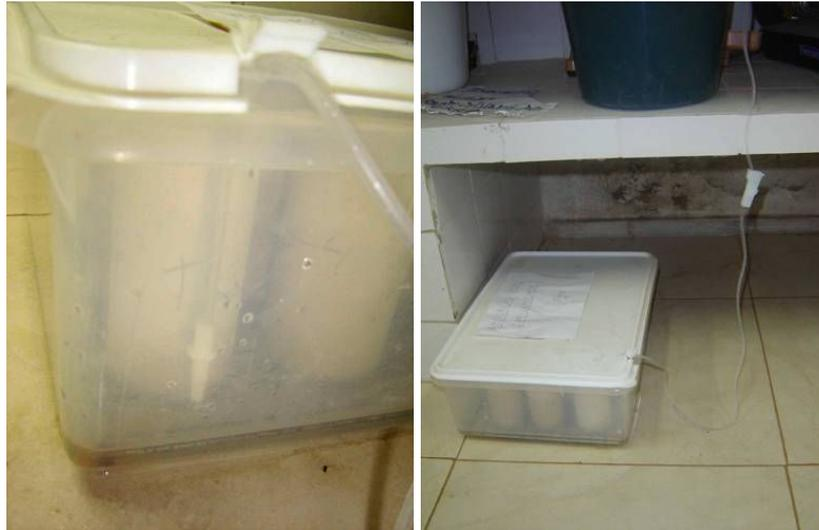
Figura 3.10 Controle do nível da água no ensaio de absorção por capilaridade
