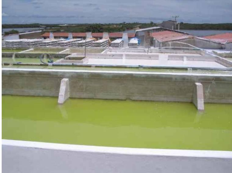
**Figura 2.4** Tanques de separação e sedimentação do caulim
