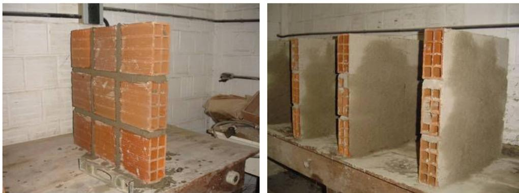
Figura 3.6 Painel sem chapisco (esquerda) e painel com chapisco (direita)
