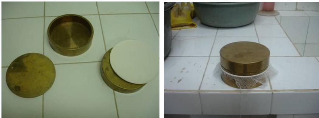
Figura 3.5 Dispositivos utilizados (esquerda) e execução do ensaio de retenção (direita)
