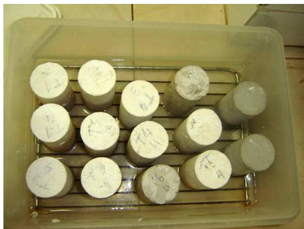
**Figura 3.9** Ensaio de absorção por capilaridade
