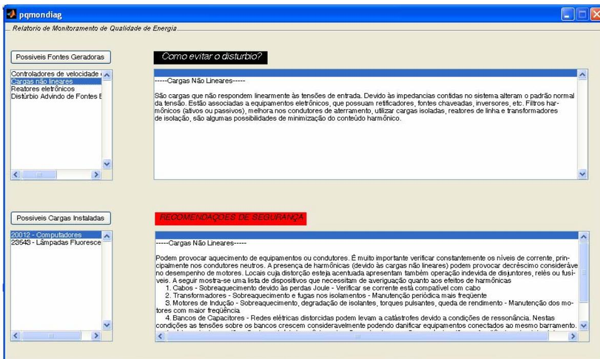
Figura 7.16. Diagnóstico referente à condição de presença de carga não linear.
