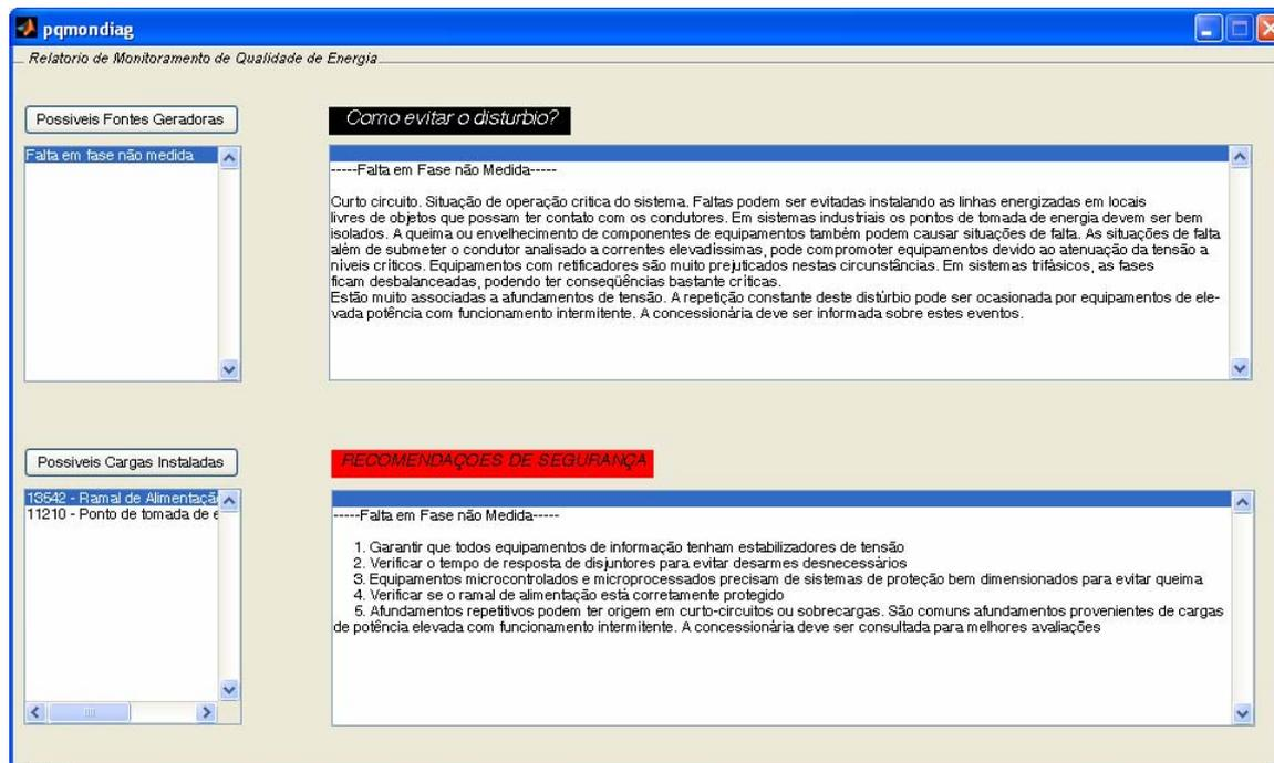
Figura 7.13. Diagnóstico referente à condição de falta monofásica em fase não medida.
