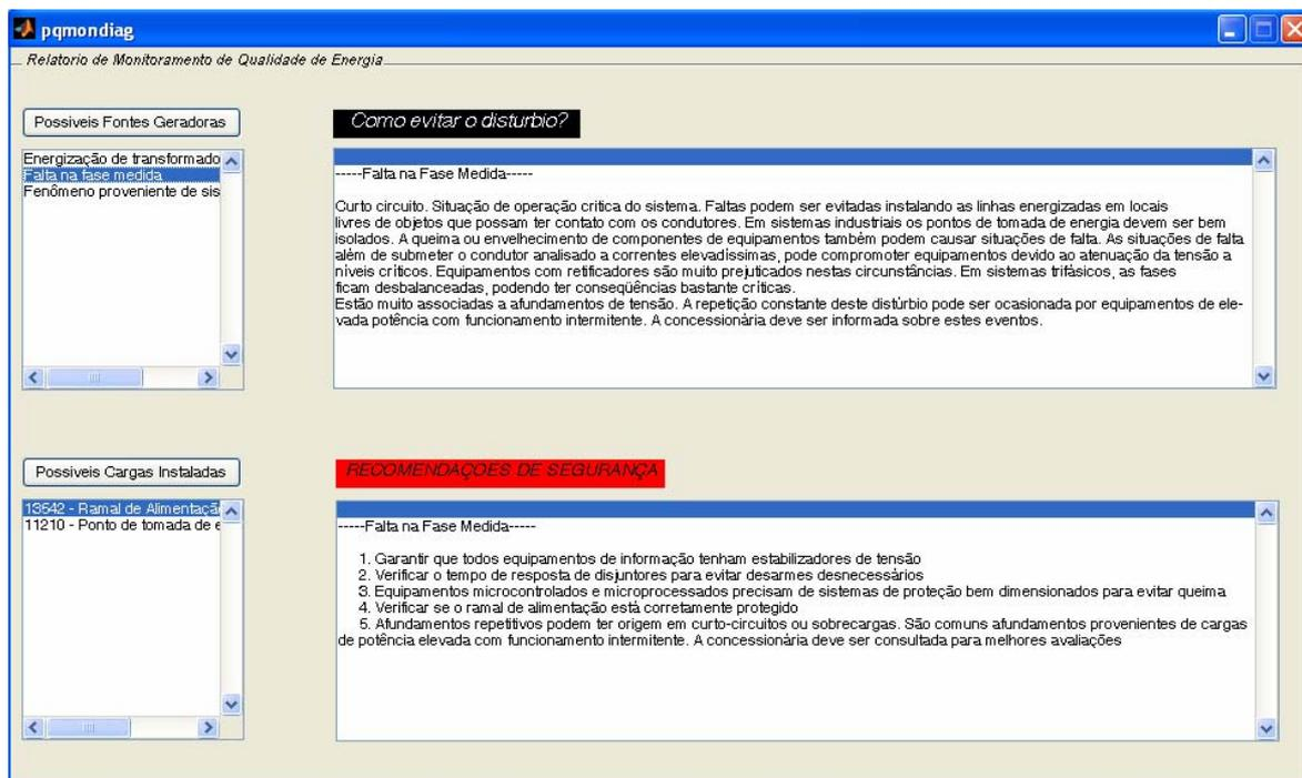
Figura 7.11. Diagnóstico referente à condição de falta monofásica na fase medida.
