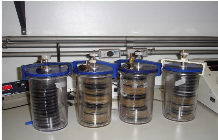
Figura 2. Sistema de incubação para bactérias anaeróbicas, jarras anaeróbicas contendo placas semeadas com amostras de solos de pastagem da micro-região de Jaboticabal – SP, no período de junho a dezembro de 2006.
