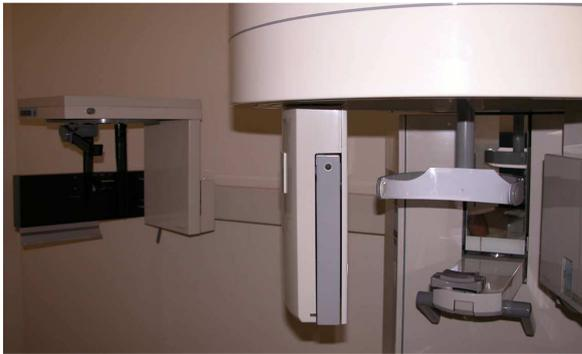
A – Aparelho Orthophos CD plus da marca Siemens montado de forma que na realização das telerradiografias laterais o lado direito da cabeça ficará mais próximo do filme.
