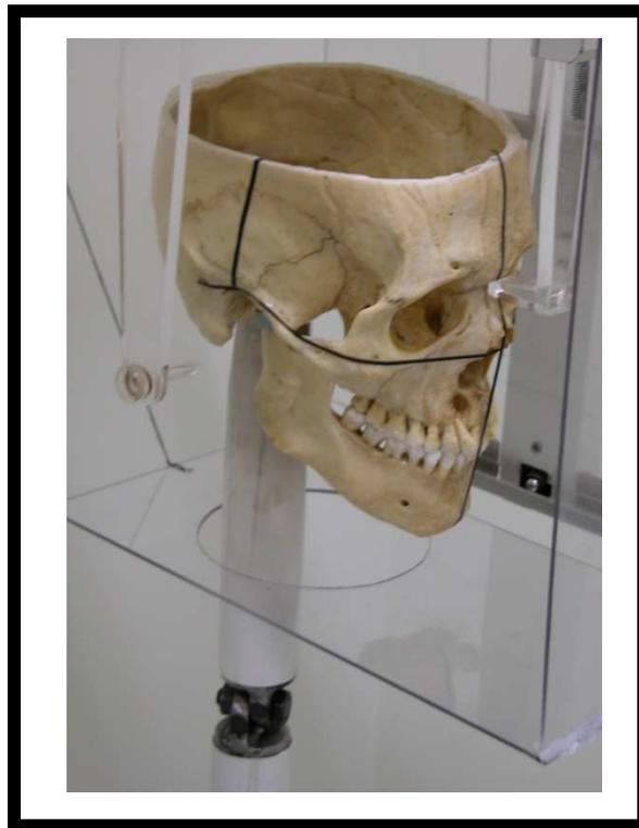
Fig. 10 – Crânio posicionado sobre um dispositivo plástico com uma articulação metálica para permitir fixação e inclinações.
