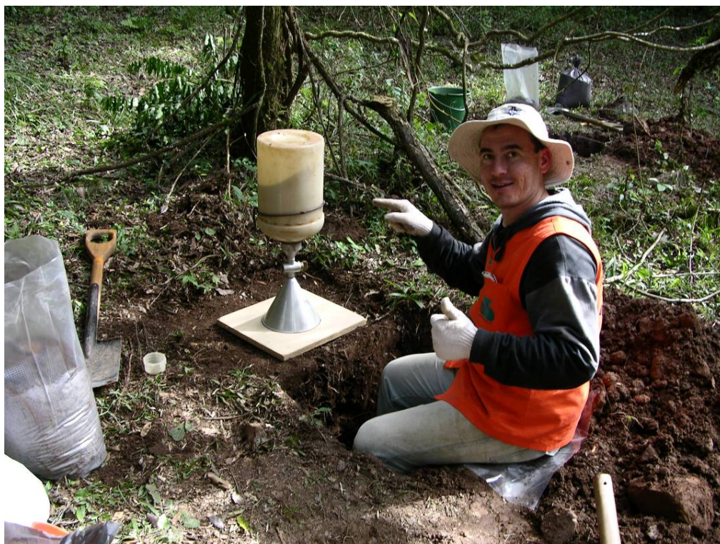
Figura 3 – Equipamento (picnômetro de areia) utilizado para a determinação da densidade pelo método da escavação.
