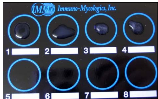
FIGURA 11 – AGLUTINAÇÃO EM LÁTEX PARA DETECÇÃO DE ANTÍGENOS CAPSULARES. DA ESQUERDA PARA A DIREITA, NA FILEIRA DE CIMA: CONTROLE POSITIVO, CONTROLE NEGATIVO, AMOSTRAS AMBIENTAIS (54 e 97)
