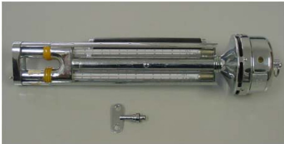
Figura 2.7: Psicrômetro. Fonte: GOUVÊA, 2004.
