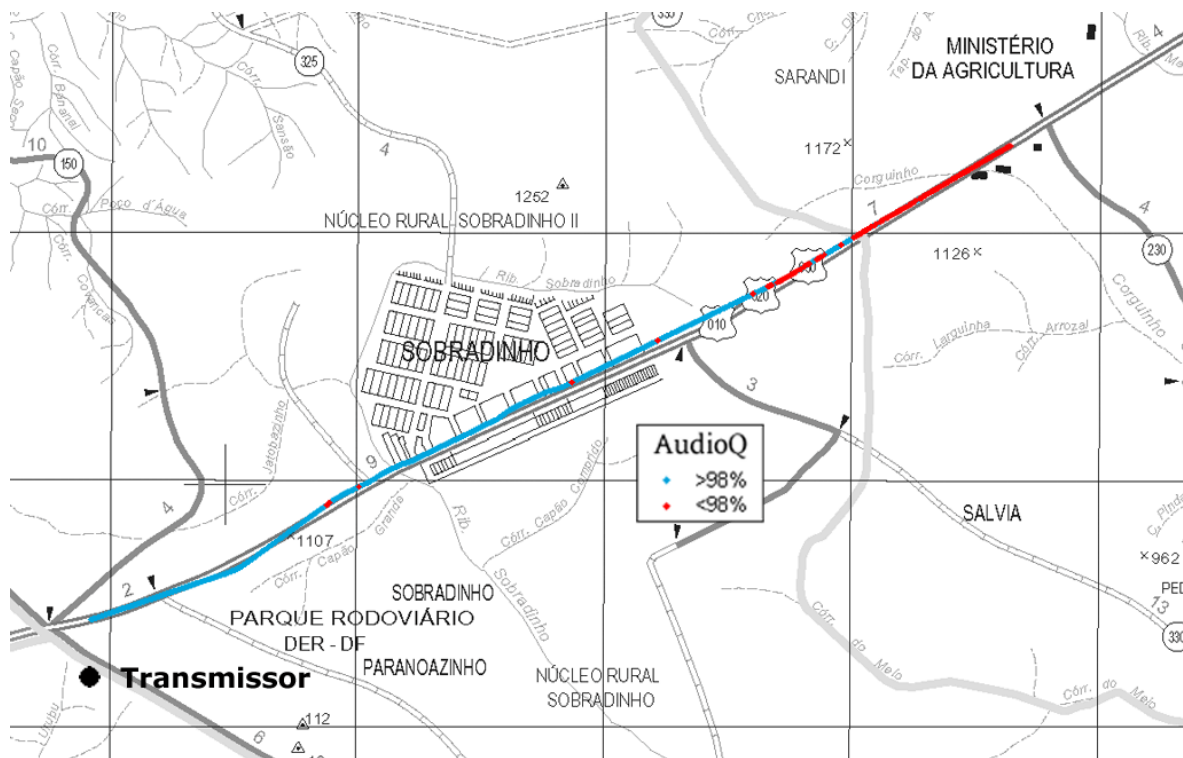
Figura 4.29 – Rota Radial NE com indicação da qualidade objetiva (AudioQ) da recepção ao longo dela, para o modo de transmissão B-21.
