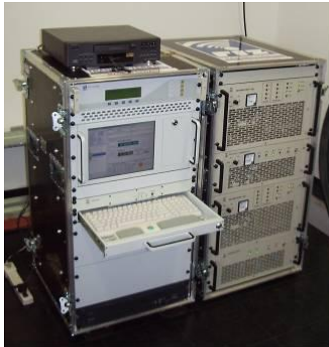
Figura 3.2 – Transmissor DRM: modulador-e-excitador (módulo da esquerda) e amplificador de RF (módulo da direita).
