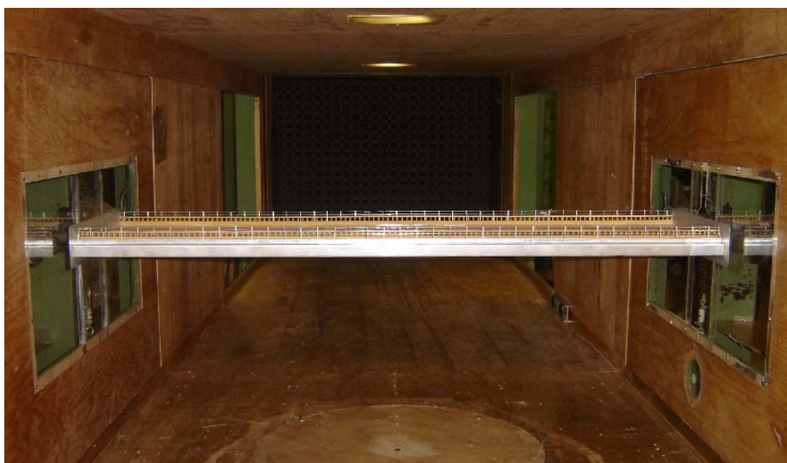
Fig. 4.19 – Modelo PO, seção original: vista geral do modelo no interior do túnel de vento.
