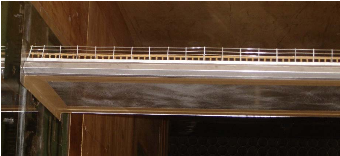
Fig. 4.23 – Modelo PCN, chapa adicionada na face inferior da PON para fechamento em forma de caixão trapezoidal.
