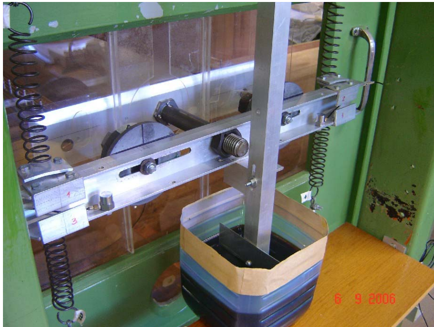
Fig. 4.27 – Sistema de apoio elástico do modelo dinâmico com o dispositivo para incremento do amortecimento do sistema.
