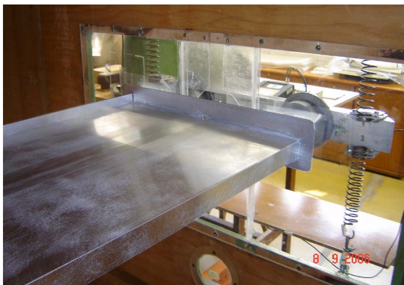
Fig. 4.20 – Modelo PT, seção tipo H ou ‘Tacoma’: vista em detalhe do modelo no interior do túnel de vento.
