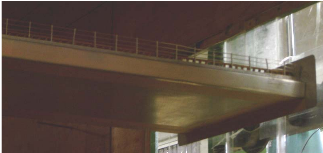
Fig. 4.24 – Modelo PC, chapa adicionada na face inferior da PO para fechamento em forma de caixão, ou, retirada dos dispositivos aerodinâmicos triangulares da PCN.
