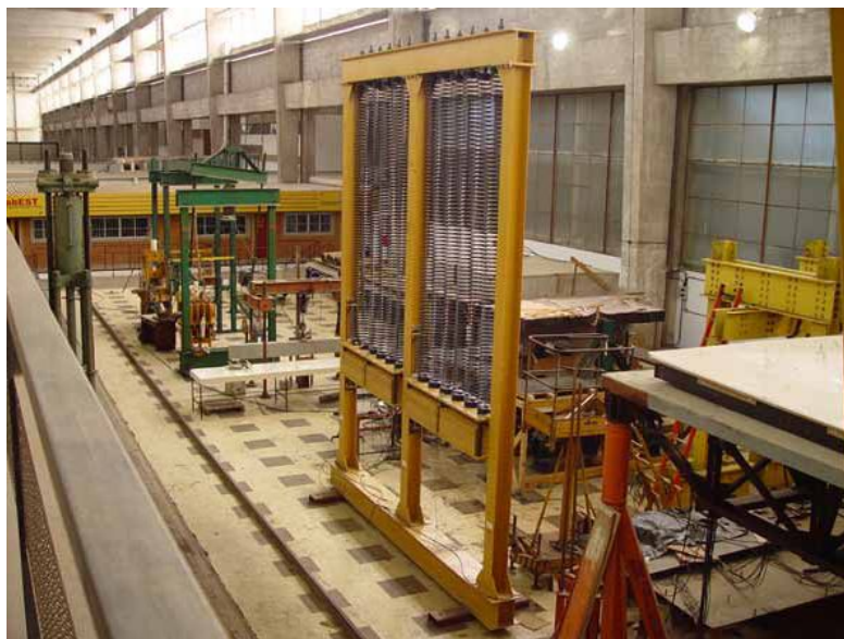
Fig. 2.19 – Pórtico com os ADS's preparados para ensaios na COPPE-UFRJ (Battista e Pfeil, 2005).
