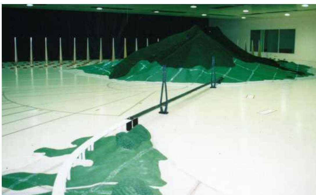
Fig. 4.7 – Modelo aeroelástico completo de escala 1:200 da Ponte Tatara - Japão.
