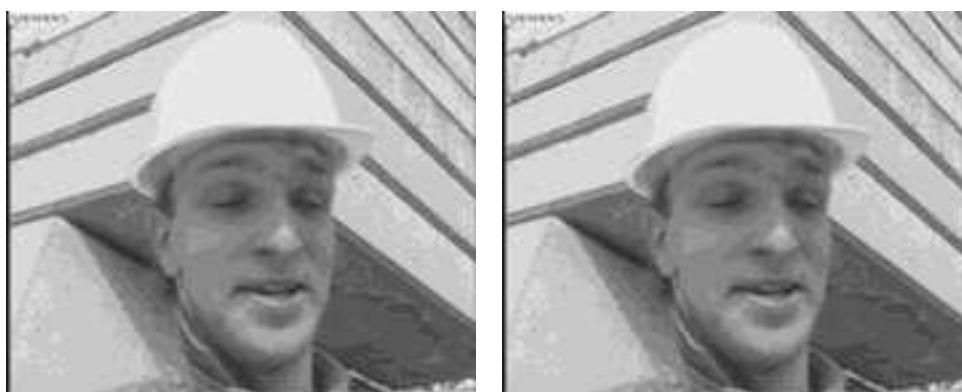
(b) Quadro quantizado no codificador. PSNR = 35.14 dB. (c) Quadro quantizado no decodificador. PSNR = 35.11 dB.
