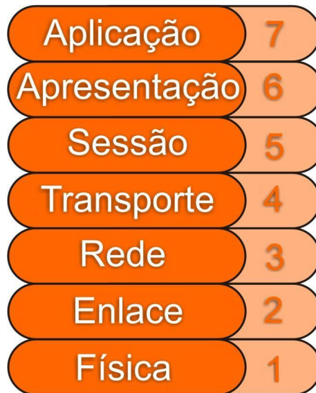
Figura 2.3: Modelo OSI de camadas
