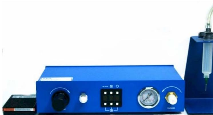
*FIGURA A.1.5 - Equipamento para aplicação manual de cola por meio de seringa por pressão.*
