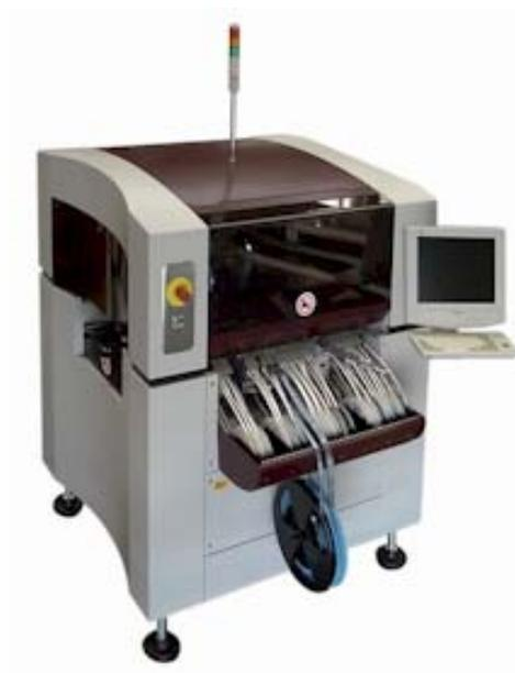
FIGURA A.1.7 - Foto de uma máquina *Pick and Place*.
