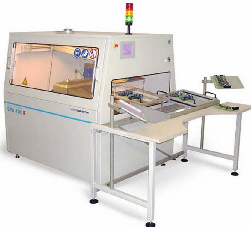
FIGURA A.1.8 - Foto de uma máquina de solda por onda.
