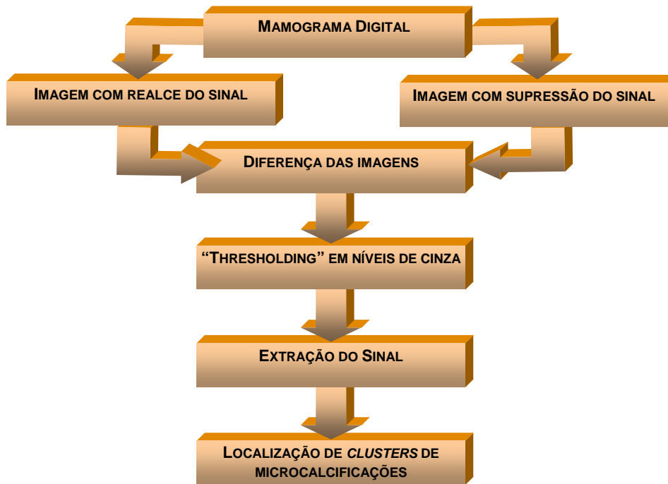
Figura 4.1 – Esquema geral da detecção computadorizada de microcalcificações em mamogramas proposta por Chan et al. (1987).
