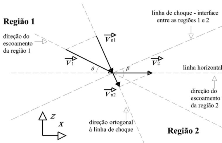
Figura 5.27 – Comportamento da velocidade de escoamento junto à interface de separação das regiões 1 e 2.
