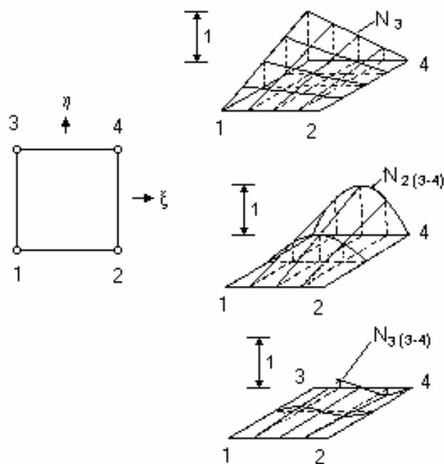
Figura 4.4 - Elemento retangular e algumas funções de expansão hierárquicas associadas.
