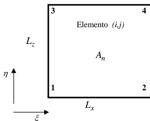
Figura A.1 - Elemento retangular de duas dimensões e seus parâmetros associados.
