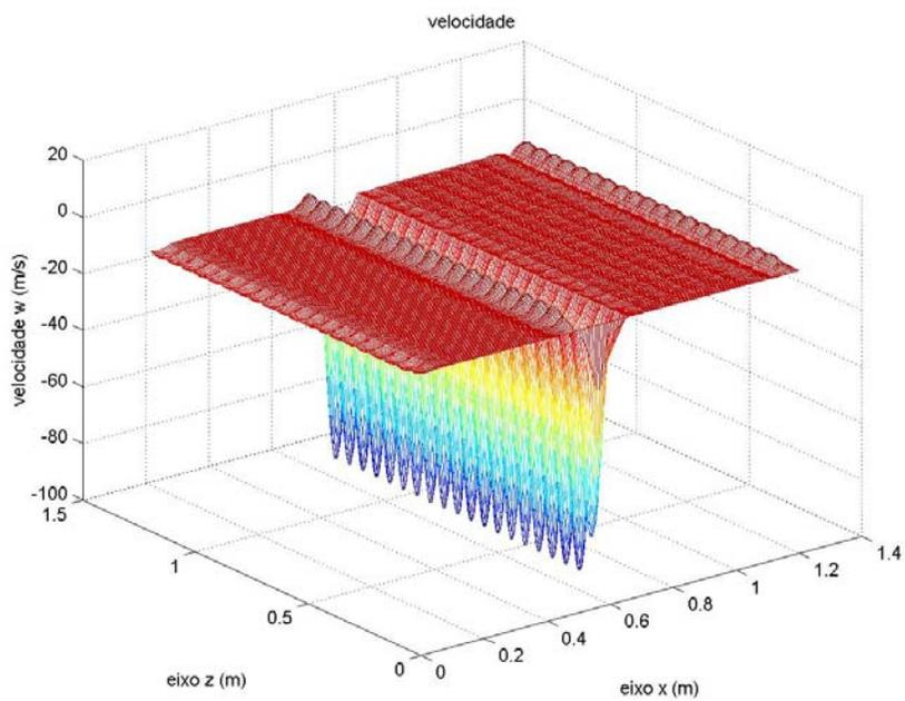
Figura 5.14 – Comportamento da velocidade  $w$  (tangencial ao choque) – malha computacional com 400 células.
