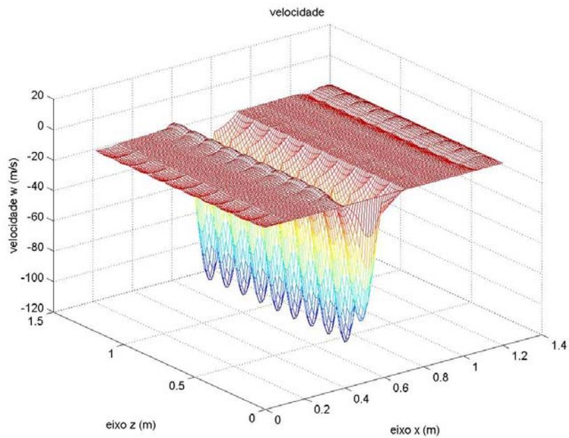
Figura 5.10 – Comportamento da velocidade  $w$  (tangencial ao choque) – malha computacional com 100 células.
