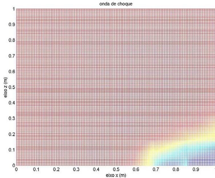
Figura 5.29 – Comportamento da onda de choque – choque oblíquo reto (solução natural), utilizando grau 2 na expansão das variáveis.
