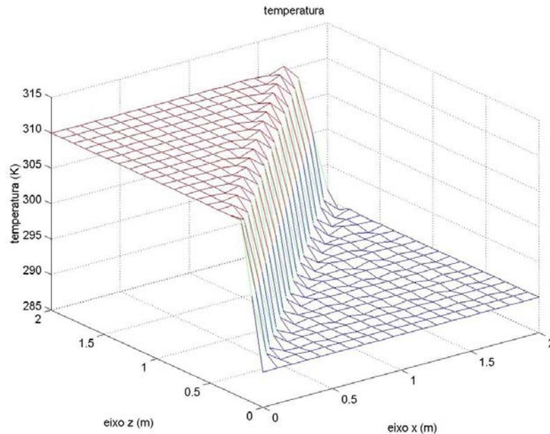
Figura 5.25 – Comportamento da temperatura – malha computacional com 100 células e grau 4 na expansão das variáveis.
