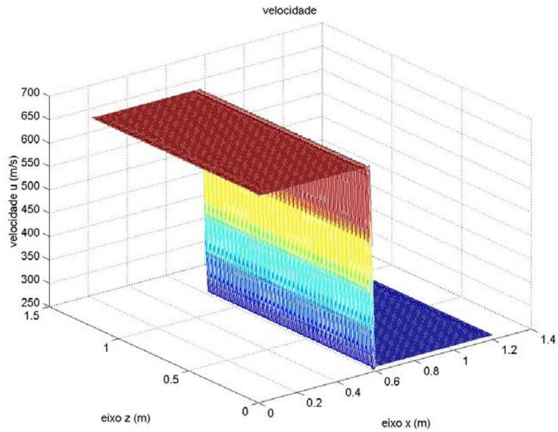
Figura 5.17 – Comportamento da velocidade  $u$  (normal ao choque) – malha computacional com 1600 células.
