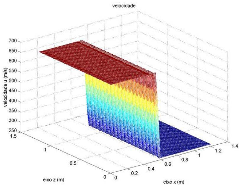
Figura 5.13 – Comportamento da velocidade  $u$  (normal ao choque) – malha computacional com 400 células.
