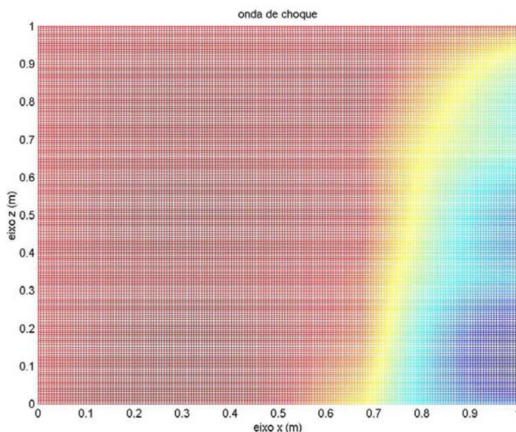
Figura 5.31 – Comportamento da onda de choque – choque oblíquo reto (solução forçada), utilizando grau 2 na expansão das variáveis.
