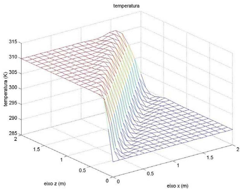
Figura 5.23 – Comportamento da temperatura – malha computacional com 100 células e grau 2 na expansão das variáveis.
