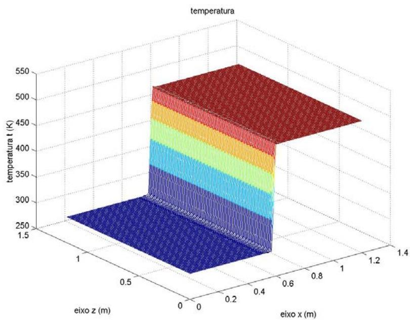
Figura 5.20 – Comportamento da temperatura – malha computacional com 1600 células.
