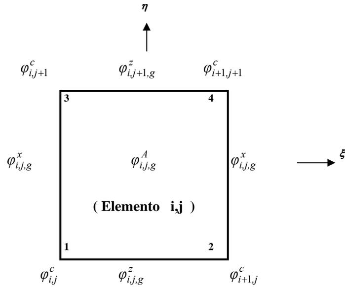
Figura 4.5 - Elemento retangular de duas dimensões e seus parâmetros associados.
