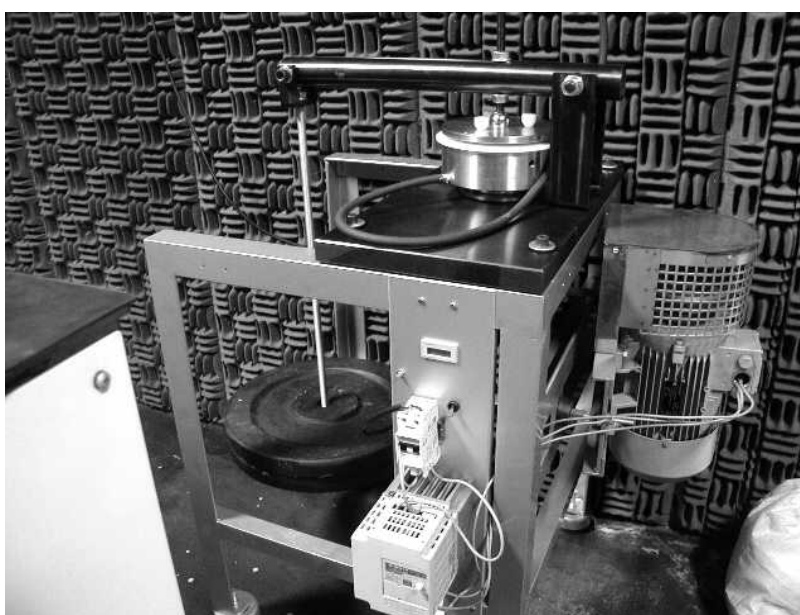
Figura 3.29 - Imagem da segunda máquina de fadiga de contato montada.
