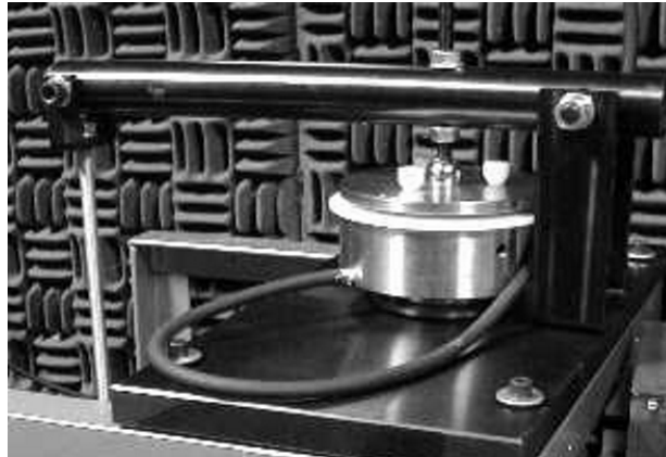
Figura 3.31 - Braço de carga apoiado sobre a tampa da máquina nova.
