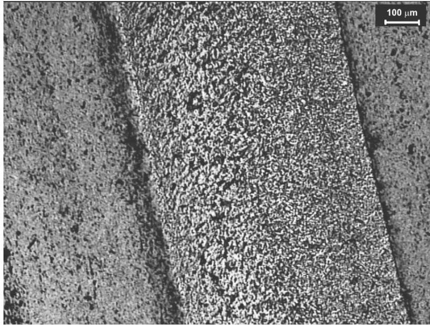
Figura 3.15 - Trilha de rolamento produzida na condição a seco. MO.
