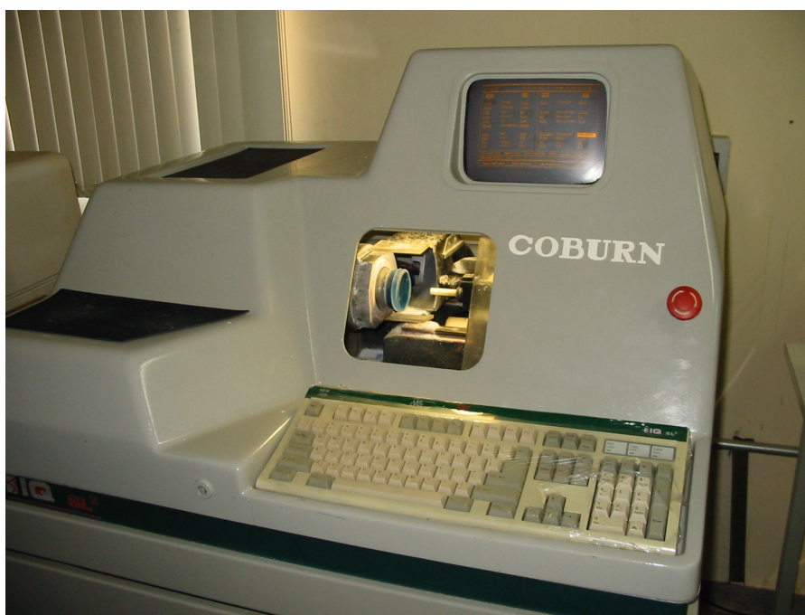
Fig. 2 - Máquina geradora. Notar a fixação da lente e a ferramenta de “torneamento” mostradas na abertura acima do teclado.
