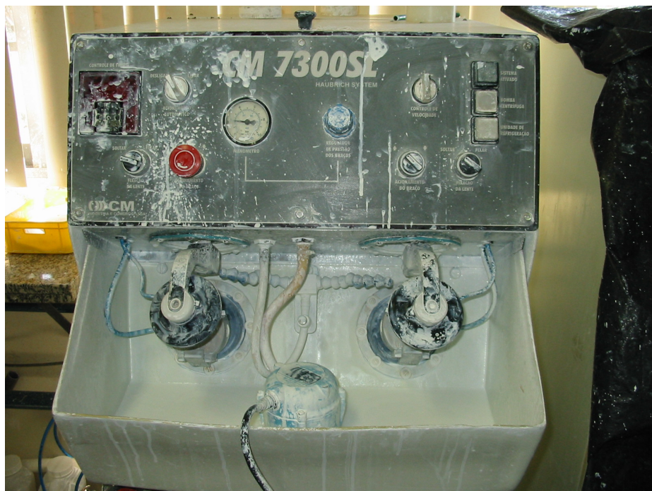
Fig. 5 - Máquina de polir usando óxido de alumínio.
