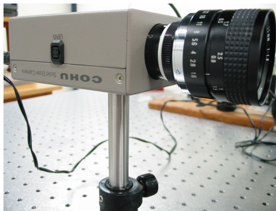
Fig. 22 - Câmera monocromática usada para a captura de imagens UV.
