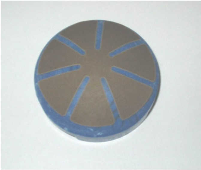
Fig. 3 - Lixa grossa aplicada ao molde.
