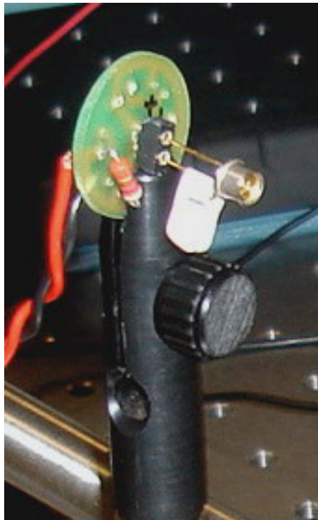
Fig. 18 - LED UV usado como fonte de luz, com comprimento de onda de 375 nm (Nichia, modelo NSHU550A).
