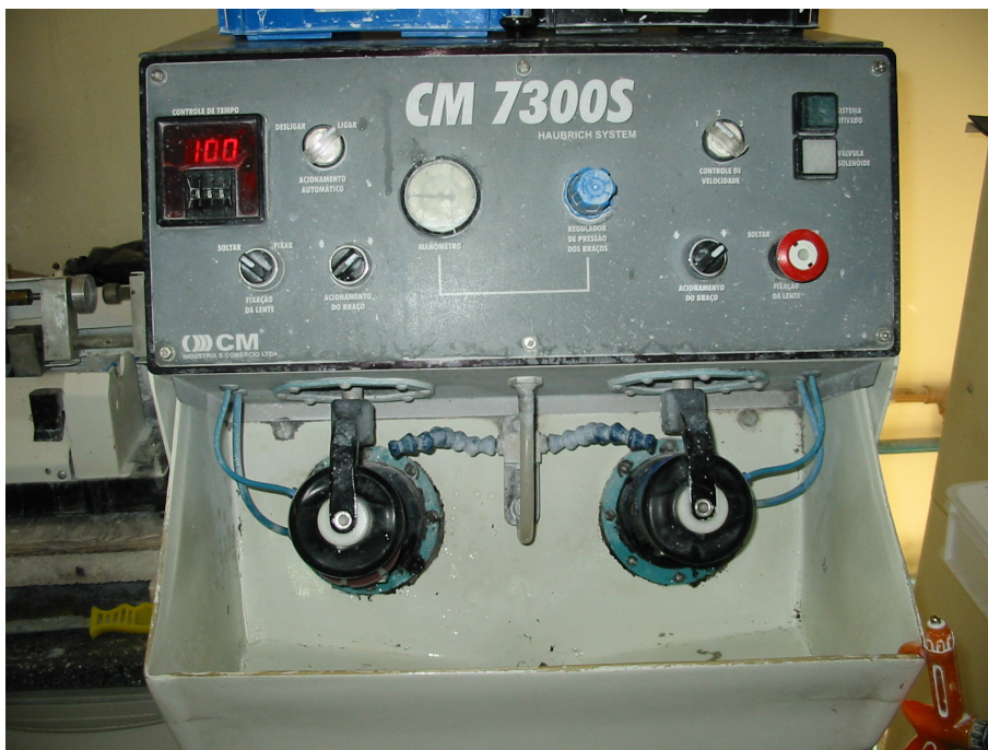
Fig. 4 - Máquina de polir. Esta mesma máquina pode ser usada com a lixa grossa ou lixa fina.
