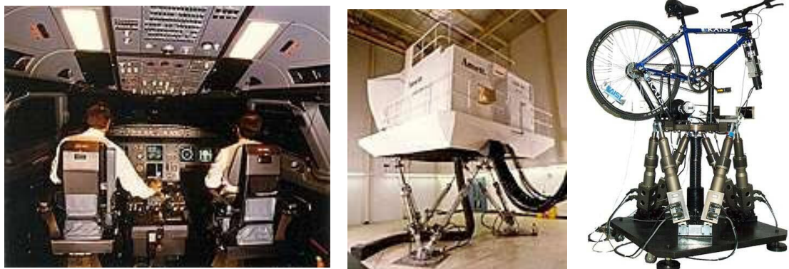
Figura 10: Simulador de vôo do Boeing 737, visão interior (à esquerda) e visão exterior (no centro) – Ansett Flight Simulator Centre, 2004 . À direita um simulador para bicicletas para estudo de vibrações – Laboratório de Controle de Vibrações do KAIST (2004) .
