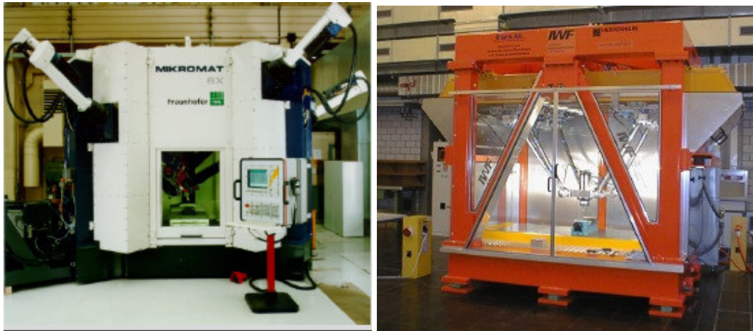
Figura 17: À esquerda uma máquina com arquitetura Hexapod, da Micromat (Blümlein, 1999), e à direita a IWF-Hexaglide (Knapp e Cobet, 2000).
