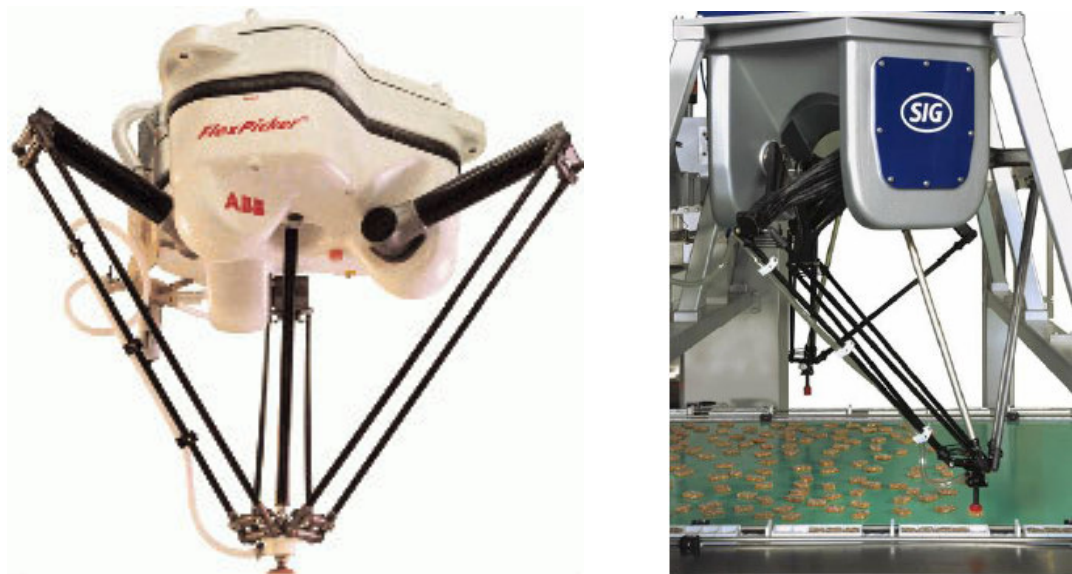
Figura 8: À esquerda, o FlexPicker™ da ABB (ABB, 2005) e à direita a máquina da SIG (Robotics Online, 2005), ambas arquiteturas Delta, inventada por Raymond Clavel.
