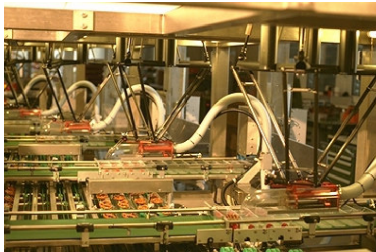
Figura 21: O Delta fabricado pela Demareux Robotique et Microtechnique SA em operação (foto extraída do LSRO, 2005).
