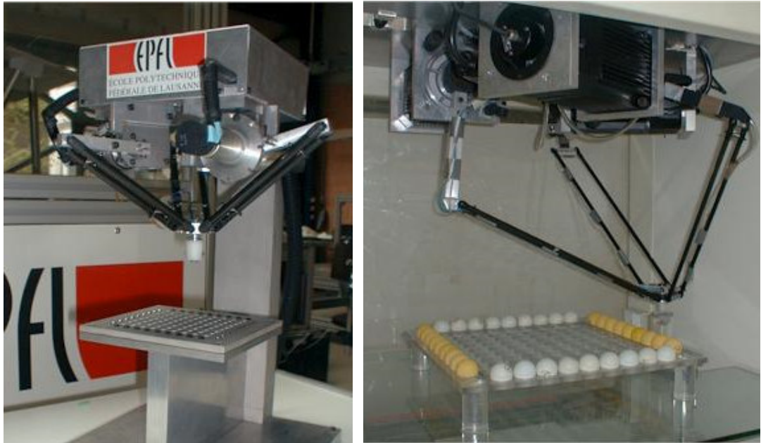
Figura 20: À esquerda o MicroDelta 240 e à direita o Delta 720 com direct drive (fotos do LSRO, 2005).
