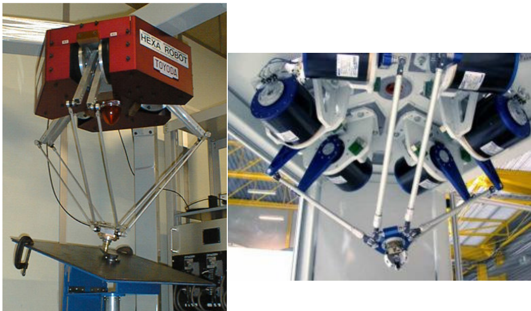
Figura 26: À esquerda, a Hexa da Toyota ( Space Machines Laboratory, 2004 ) e à direita a Hexa do IWF ( 2004 ).
