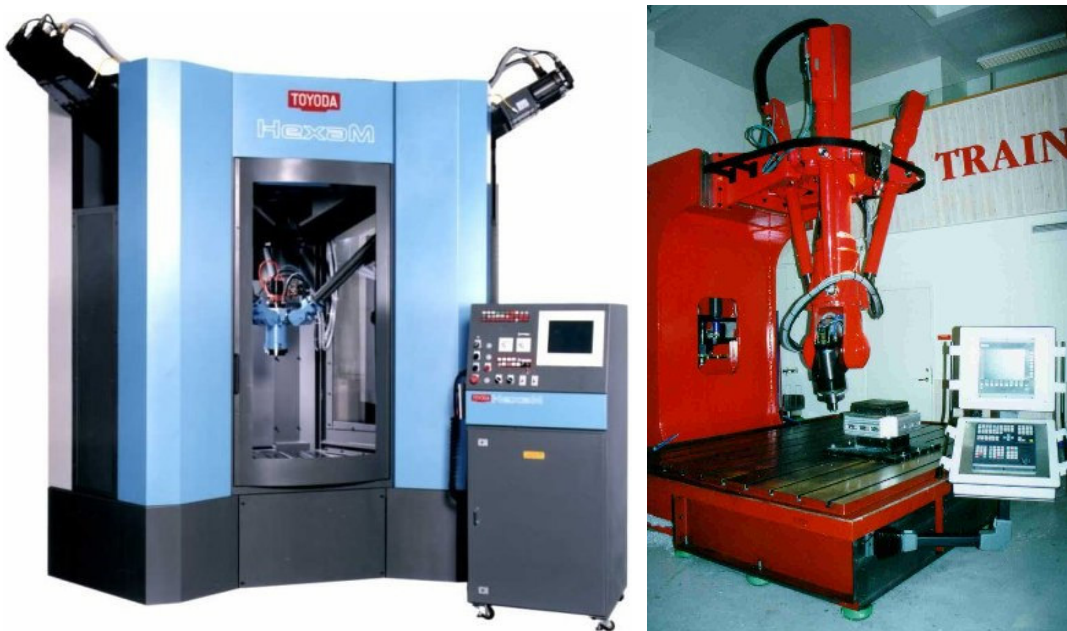
Figura 18: À esquerda, a HexaM da Toyoda Machine Works Ltda. (Parallemic, 2002) e à direita o Tricept da Neos Robotics (Robotics Online, 2004).
