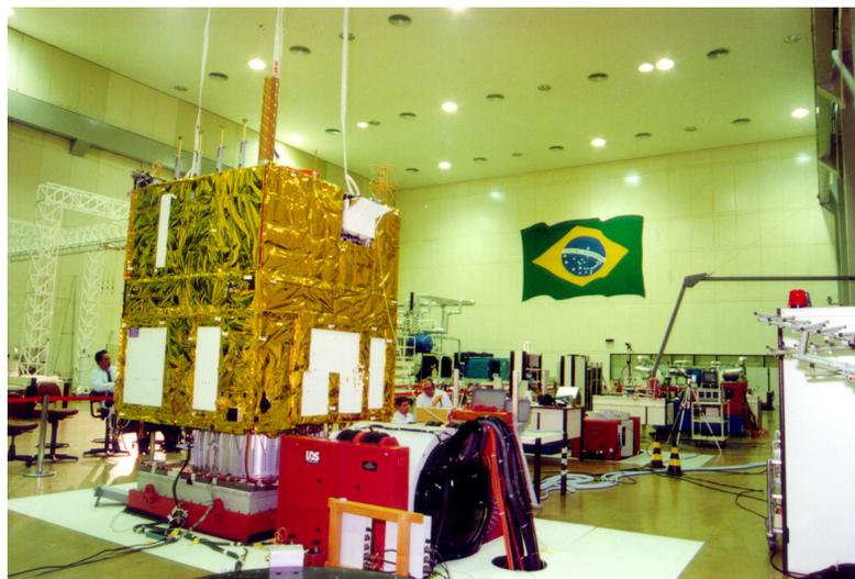
**Figura 1.1: Vista do LIT-INPE: CBERS-2 durante teste de vibração**
