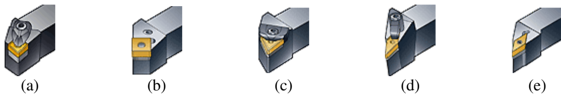
Fig. 2.10. Ferramentas com pastilhas intercambiáveis. (a) fixação rígida, (b) fixação por alavanca, (c) fixação por cunha e grampo, (d) fixação por parafuso e grampo de topo, (e) fixação por parafuso (SANDVIK, 2005)
