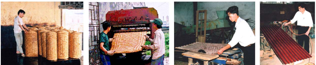
Figura 33. Processo de fabricação do painel ondulado (Fonte: http://www.bamboocomposites.com ).
