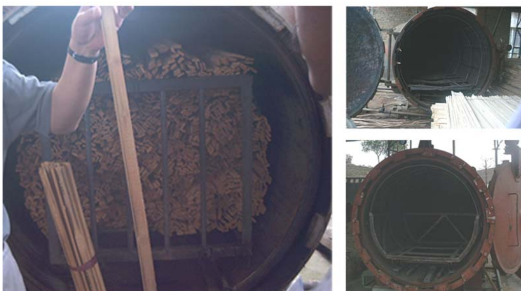
Figura 16- Forno ou caldeira para a carbonização das ripas, China. (Fotos: MARCO PEREIRA, 2000).
