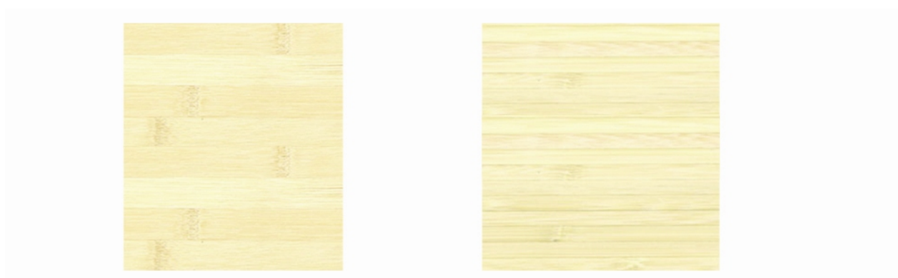
Figura 15- Lâminas de bambu descoradas, alvejadas ( Bleaching ).
