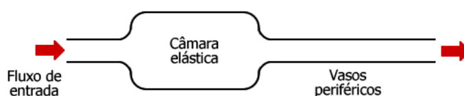
Figura 2-1 Modelo windkessel composto por dois elementos, um capacitivo e um resistivo (adaptado de FUNG, 1997).
