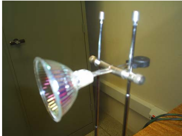
FIGURA 27- Lâmpada dicrónica halógena 12V, 50W, \bar{\lambda}=633 nm, da marca OSRAM, utilizada para obtenção da reconstrução óptica do elemento de luz branca.
