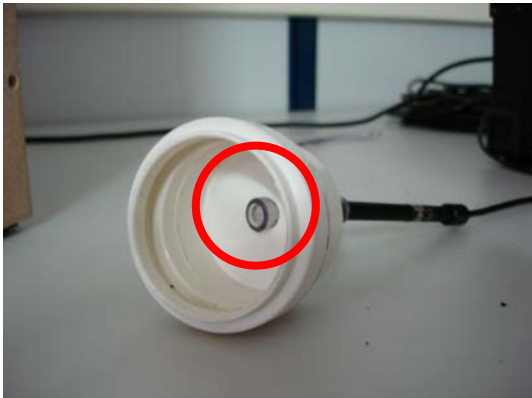
Figura 8 – Canal auditivo simulador (visão interna)
