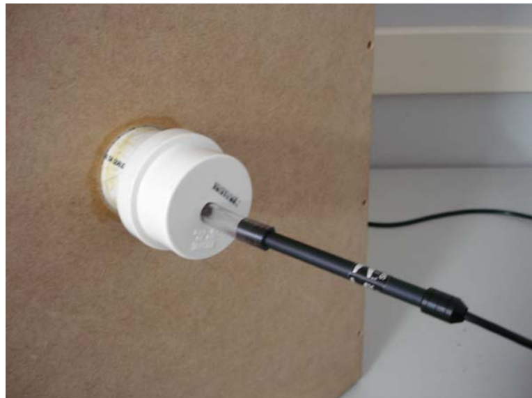
Figura 7 – Microfone acoplado ao conduto auditivo simulador humano.
