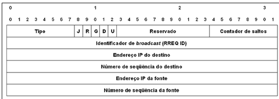
Figura 10: O formato de uma mensagem de requisição de rota RREQ do AODV
