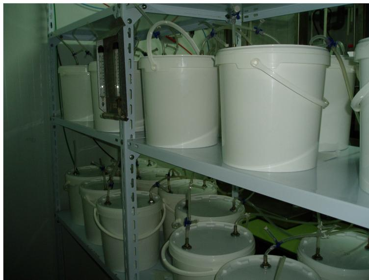
**Figura 4. Aplicação da atmosfera controlada em potes plásticos (5% O<sub>2</sub>:5% CO<sub>2</sub> e 5% O<sub>2</sub>:1% CO<sub>2</sub>).**
