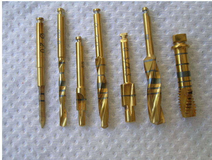
FIG. 6 Seqüência de brocas para instrumentação de implantes cilíndricos e macho de rosca.
