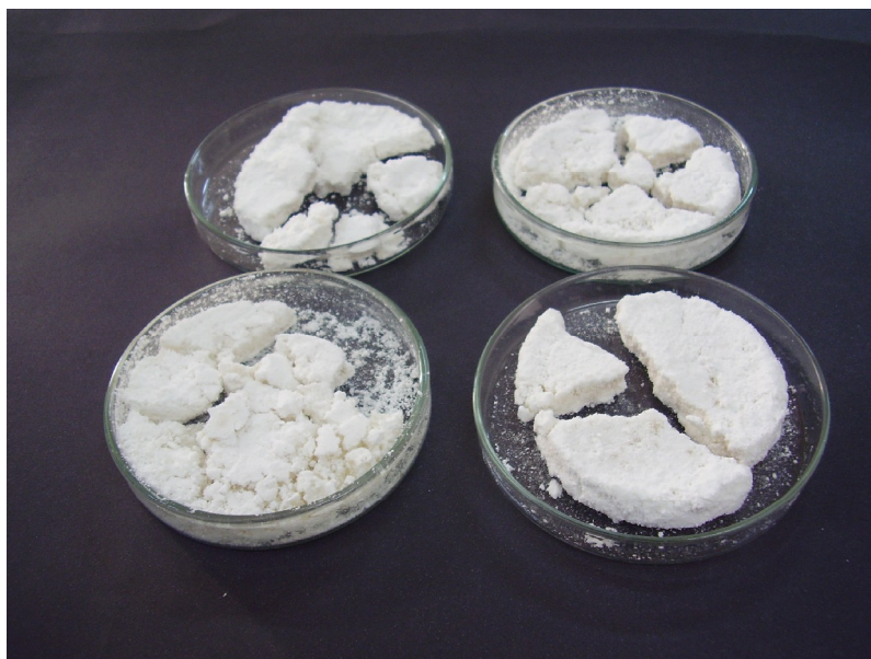
Figura 12 - Aspecto do amido de mandioca-salsa (35% de umidade) gelatinizado, submetido ao tratamento TTBU em forno convencional
