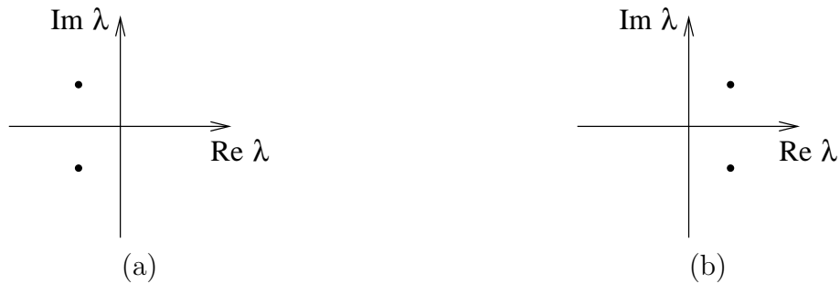
Figura 1.10: Representação no plano complexo dos autovalores de espiral bidimensional (a) estável e (b) instável
