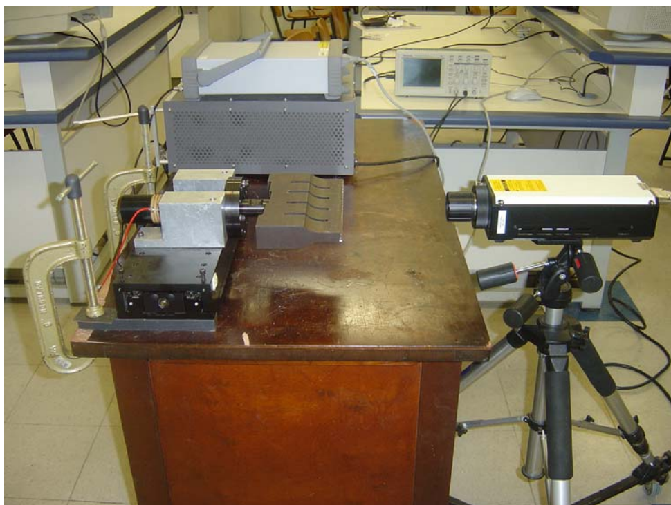
Figura 7.3.7.3. Fotografia tirada durante as medições com o vibrômetro da distribuição de vibração ao longo da face de trabalho do sonotrodo lâmina-larga.
