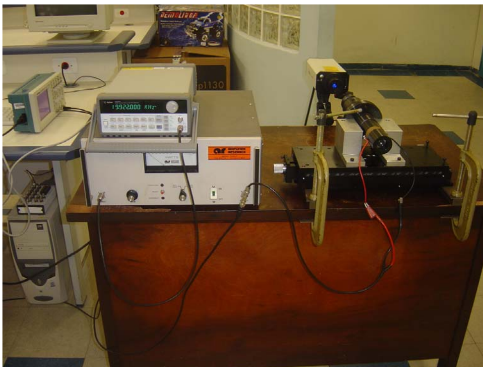
Figura 7.3.6.2.7. Fotografias tiradas durante as medições com o vibrômetro da distribuição de vibração ao longo da face de trabalho do sonotrodo cilíndrico otimizado.
