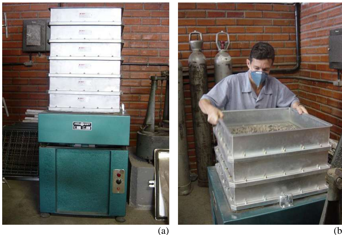
Figura 4.7 - (a) Peneirador mecânico e conjunto de peneiras (b) e execução do ensaio
