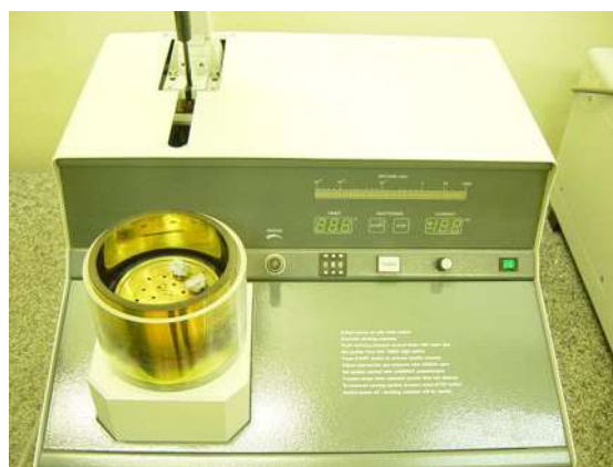
Figura 4.14 - (a) Colocação da camada de prata nas amostras fixadas em suporte de pino (b) e metalizador
