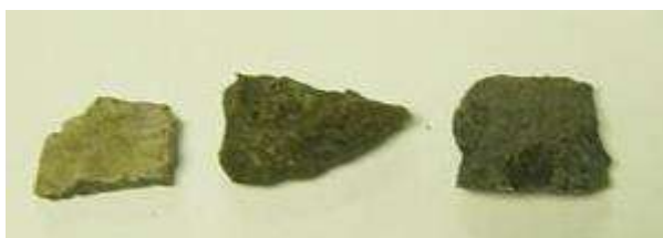
Figura 4.13 - Fraturas de grãos de escória de aciaria para observação em MEV
