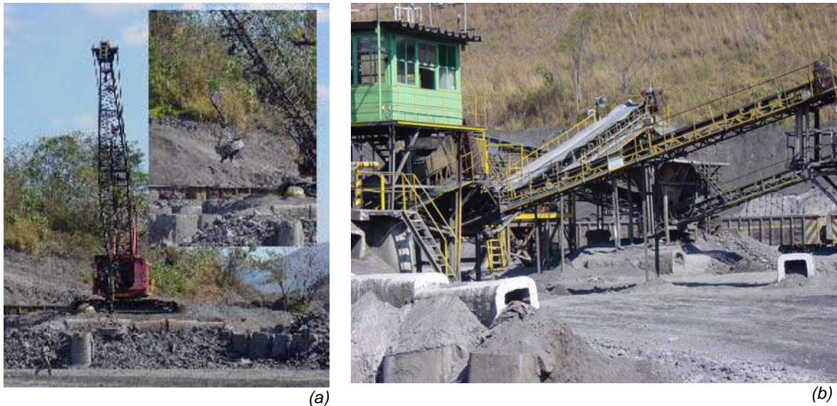
Figura 2.7 - (a) Separação de grandes placas metálicas da escória de aciaria por eletro-ímã. (b) Planta de britagem e separações magnética e granulométrica da escória de aciaria (SOUZA, POLESE, 2003).
