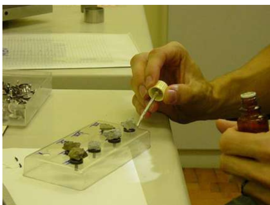
Figura 4.14 - (a) Colocação da camada de prata nas amostras fixadas em suporte de pino (b) e metalizador
