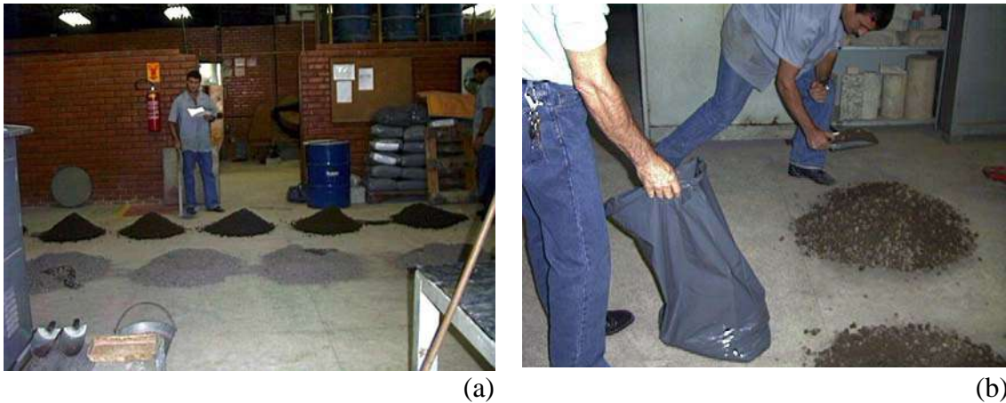
Figura 4.4 - (a) Vista dos cinco montes (b) e coleta de amostra parcial para formar pilha de homogeneização
