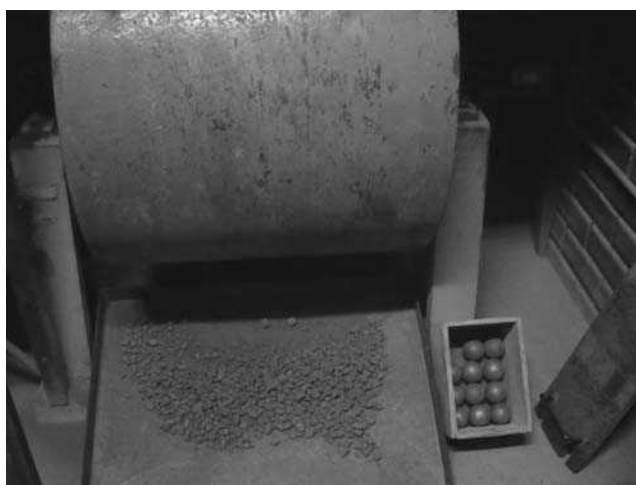
Figura 4.10 - Máquina de abrasão Los Angeles, carga abrasiva e material retirado ao final da 500 rotações.
