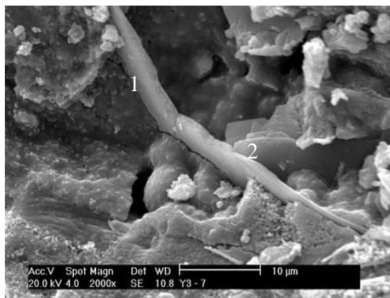
Figura 5.35 - Monossulfoaluminato de cálcio (1), Aluminato de cálcio (2)
