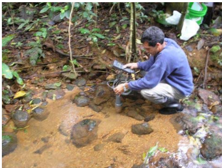
Figura 15. Medição das variáveis físicas e químicas da água, tomadas com auxílio de multisensor Water Quality Checker, U-10 (Horiba)
