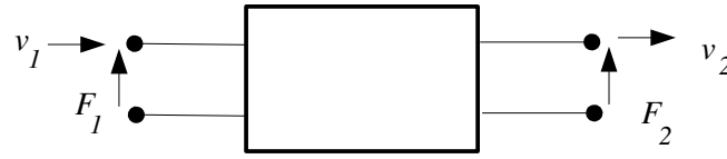
Figura 5.5. Modelo do elemento passivo.
