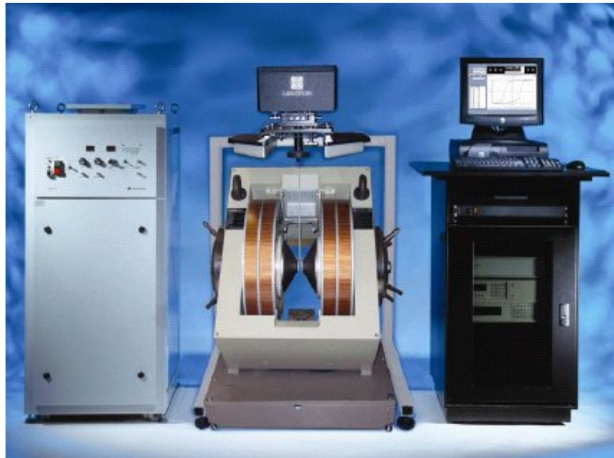
Figura 3.7 - Magnetômetro de amostra vibrante (MAV) marca LakeShore modelo 7410 Fonte: Laboratório de Materiais e de Baixas Temperaturas IF/UNICAMP.
