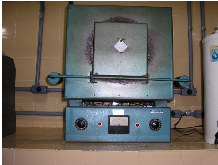
Figura 3.6 – Forno elétrico tipo Mufla ENGRO Modelo 355 (15x15x25)cm Fonte: Laboratório de materiais cerâmicos do ICE/UNIFEI
