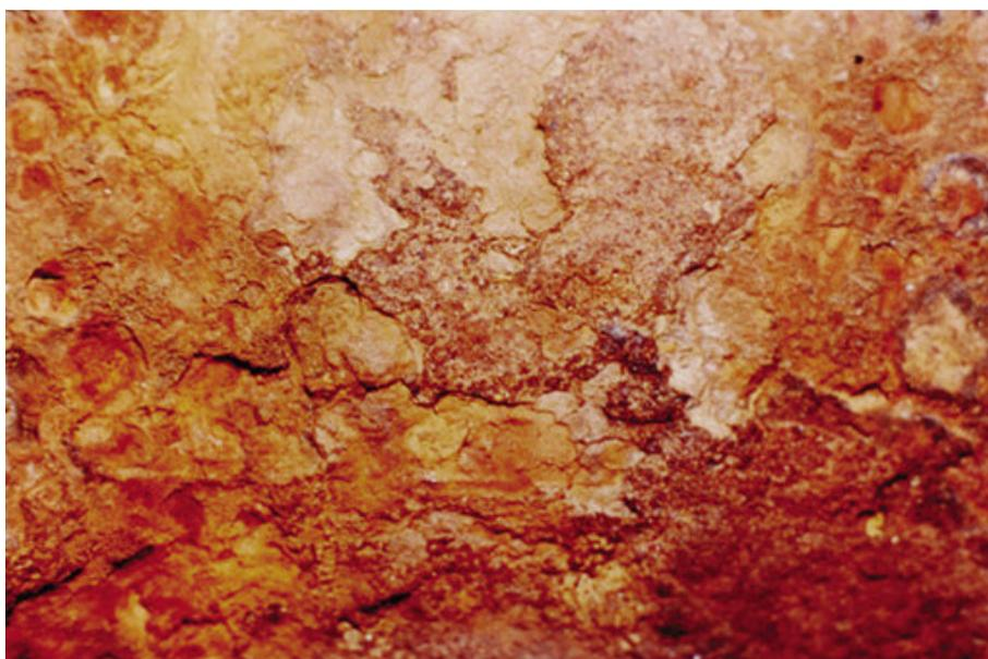
Figura 2.5 – Corrosão uniforme em chapa de aço carbono (GENTIL,2003).
