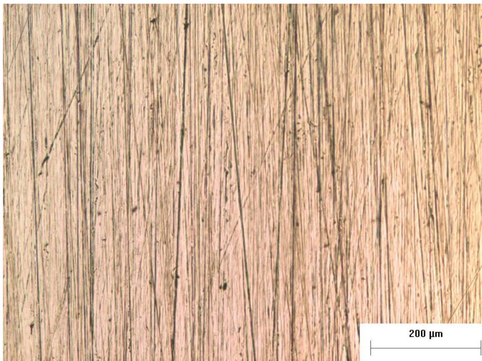
Figura 4.3 – Micrografia obtida em microscópio ótico referente ao corpo-de-prova SS<sub>16</sub> após ensaio potenciodinâmico em meio NaCl 0,5 mol/dm<sup>3</sup>.
