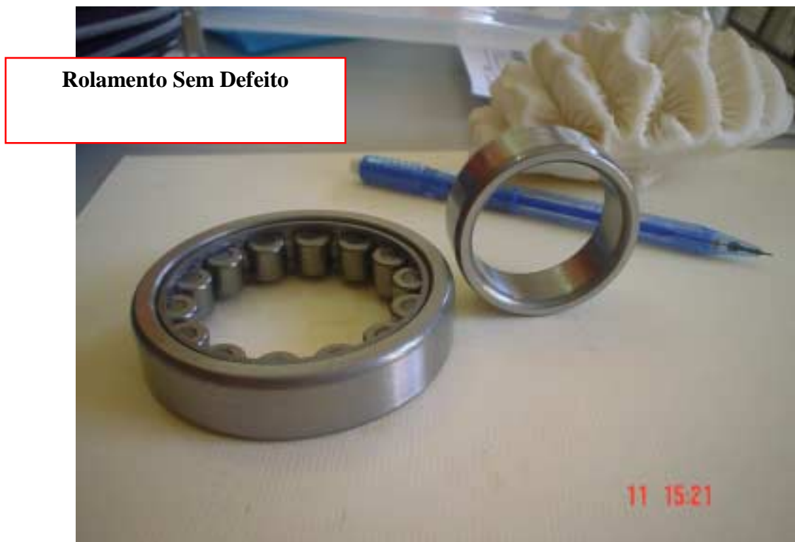
Figura 5.25 – Rolamento sem defeito – classe K1
