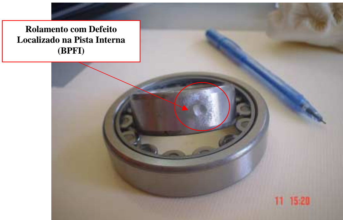
Figura 5.23 – Rolamento com defeito na pista interna – classe K2
