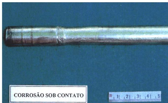
Corrosão sob Contato (Fresta) – Tubo de Permutador de Calor.
