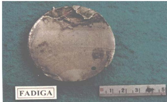
Fadiga – Eixo de Motor de Bomba.
