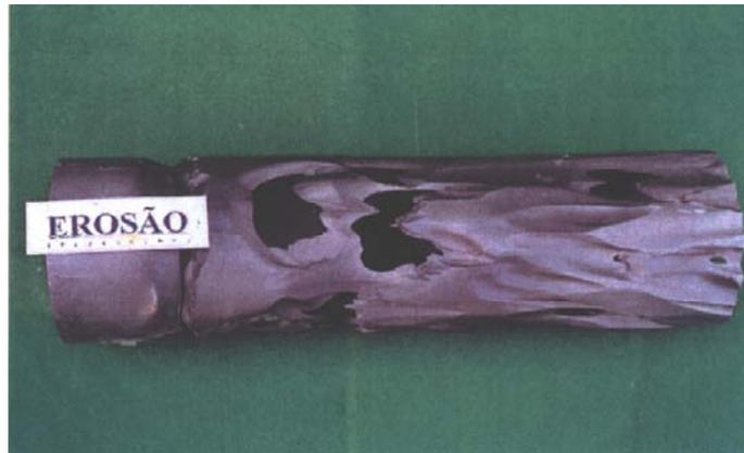
Figura 30 – Erosão – Tubo Interno de Conversor.
