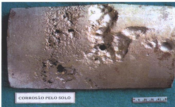
Corrosão pelo Solo – Tubo de Condução.
