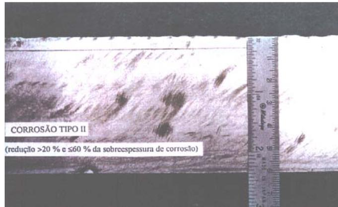
Figura 9 – Corrosão Tipo II – Material: ASTM A 285 – Gr [17].
