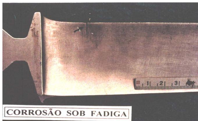
Corrosão sob Fadiga – Palheta de Rotor de Soprador.
