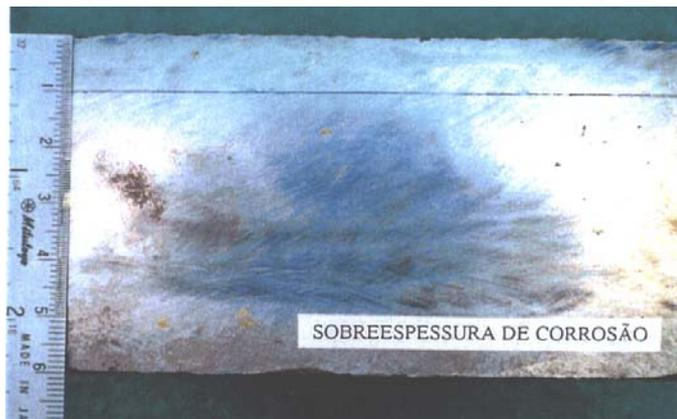
Figura 7 – Sobre espessura de corrosão – Foto referencial para a classificação de Corrosão - Material: ASTM A 385 Gr [17].
