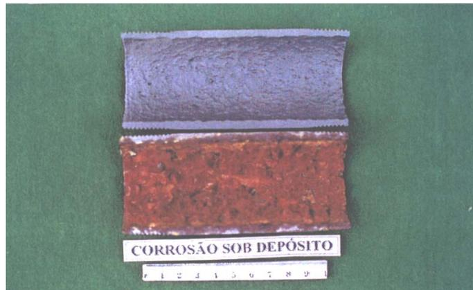
Corrosão sob Depósito – Tubo de Condução de Água.
