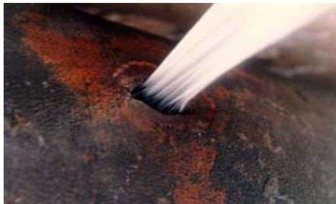
Figura 16 - Corrosão Por Corrente de Fuga [19].
