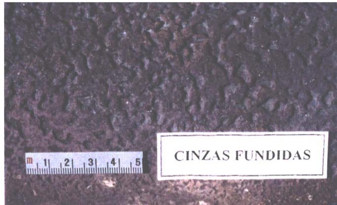
Corrosão por Cinzas Fundidas – Tubo de Forno de Destilação.
