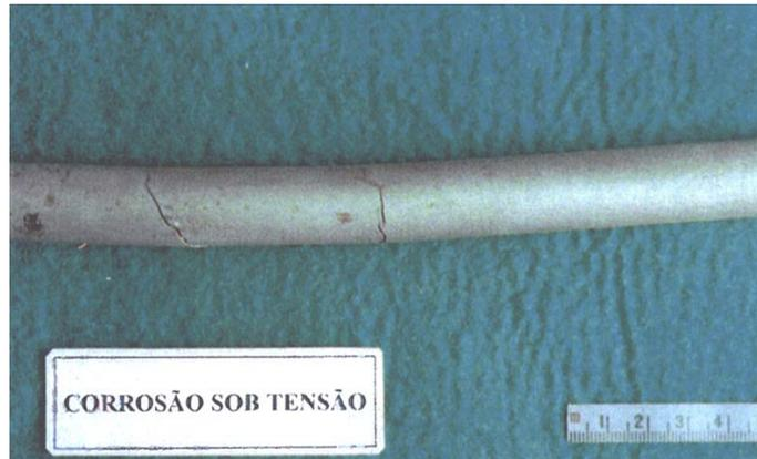
Corrosão sob Tensão – Tubo de permutador de Calor.
