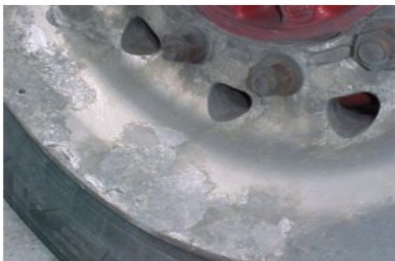
Figura 35 - Roda de Liga de Alumínio Corroída [53].
