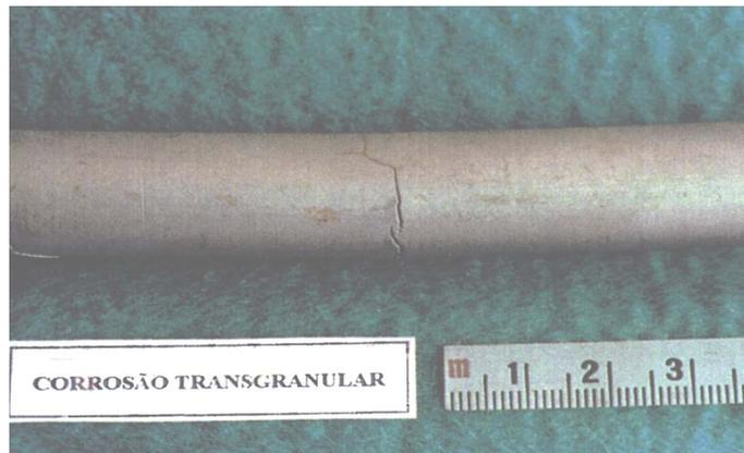
Trinca Transgranular – Tubo de Permutador de Calor.
