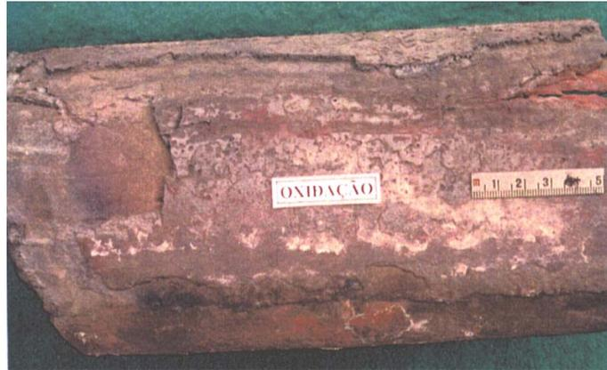
Oxidação a Altas Temp. – Tubo de Forno de Destilação.
