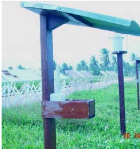
Figura 17 - Vela Coletora de Cloretos e Suporte da Vela [23].
