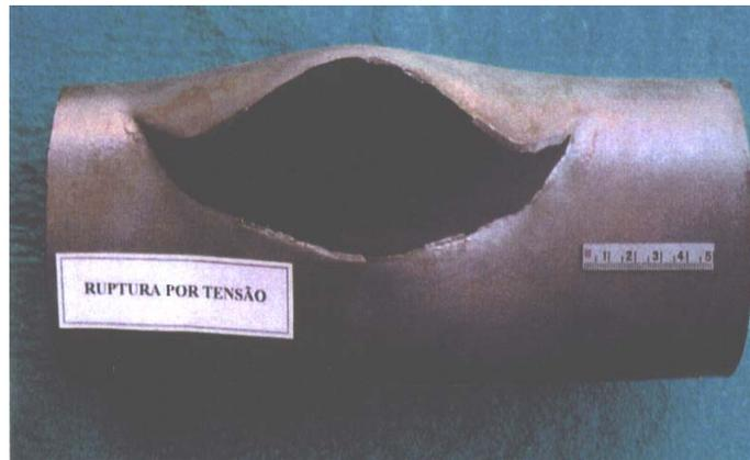
Ruptura por Tensão – Tubo de Forno de Desasfaltação.
