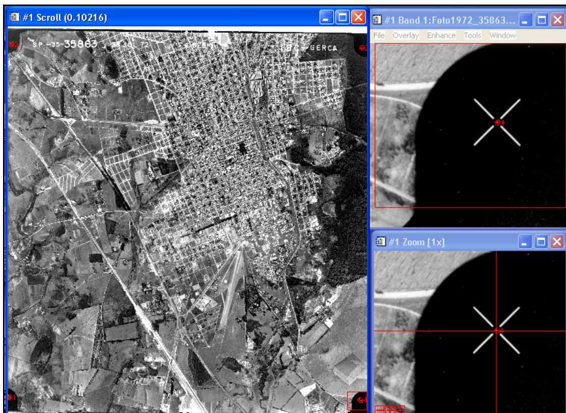
Figura 3 – Marcas fiduciais da foto aérea 35863 – 1972 definida pela orientação interna da câmera
