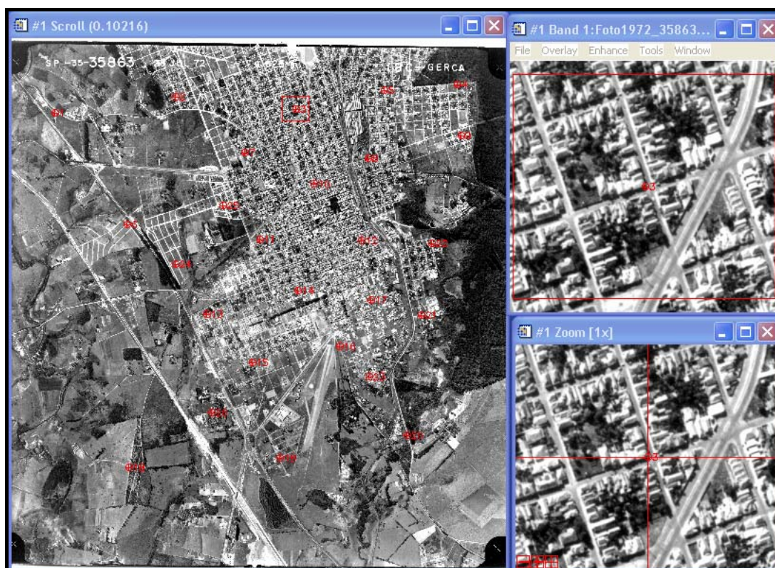
Figura 4 – Pontos de controle da foto aérea 35863 – 1972 definida pela orientação externa
