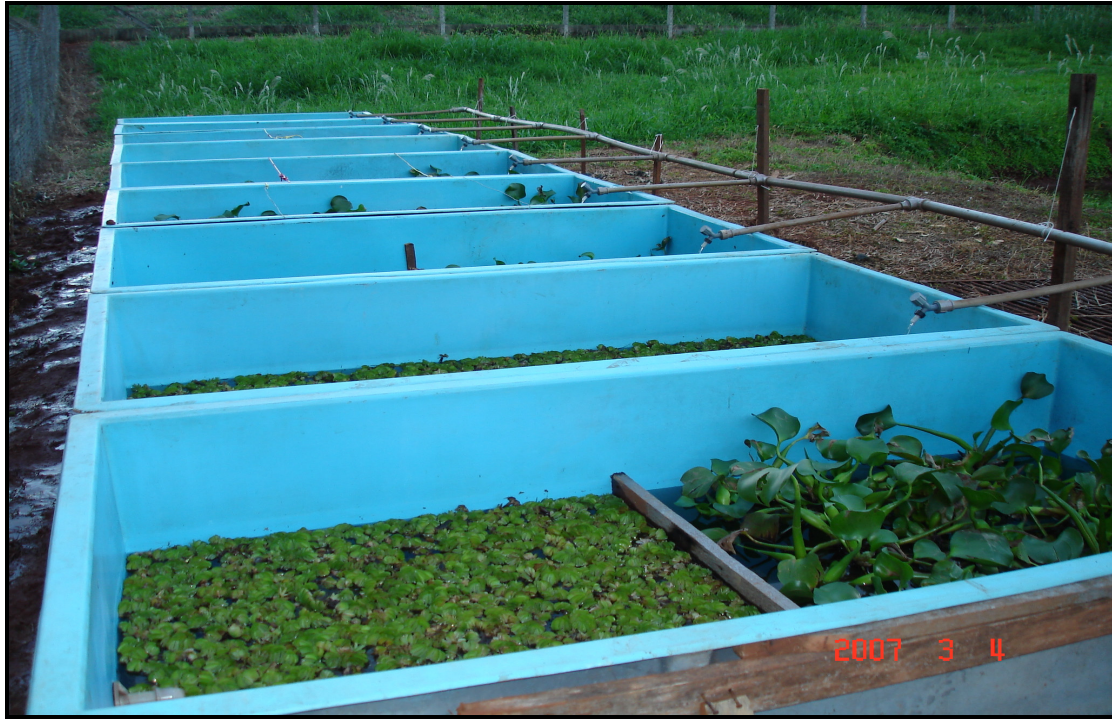
Figura 2. Wetland construída para o tratamento do efluente do viveiro de manutenção de camarões reprodutores da espécie Macrobrachium rosenbergii .
