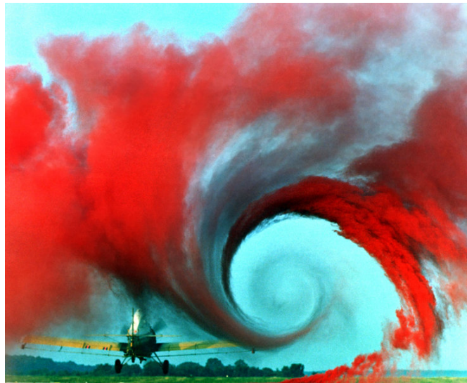
Figura 2.7: Foto clássica ilustrando o forte vórtice formado na ponta da asa de um monomotor agrícola.
