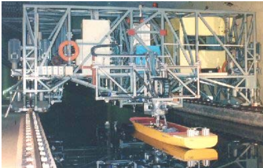
Figura 4.1: Montagem de um modelo em carro de reboque (extraído de Leewen; Journée, 2001)
