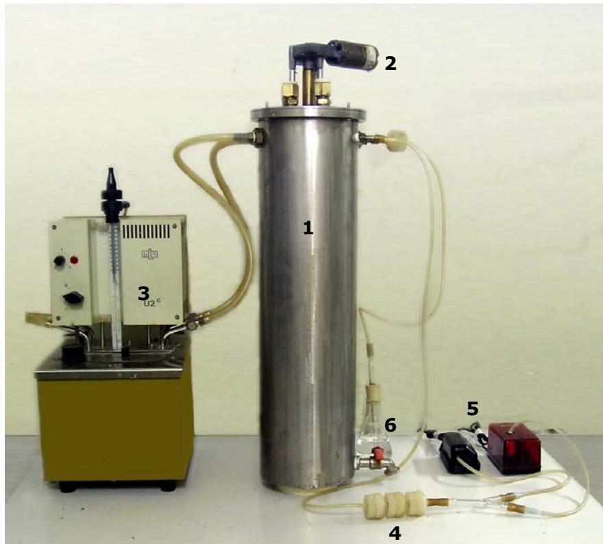
Figura 16: Sistema completo do biorreator: (1) biorreator, (2) motor, (3) banho circulante, (4) filtros de ar, (5) compressores de ar, (6) captação de CO 2 .
