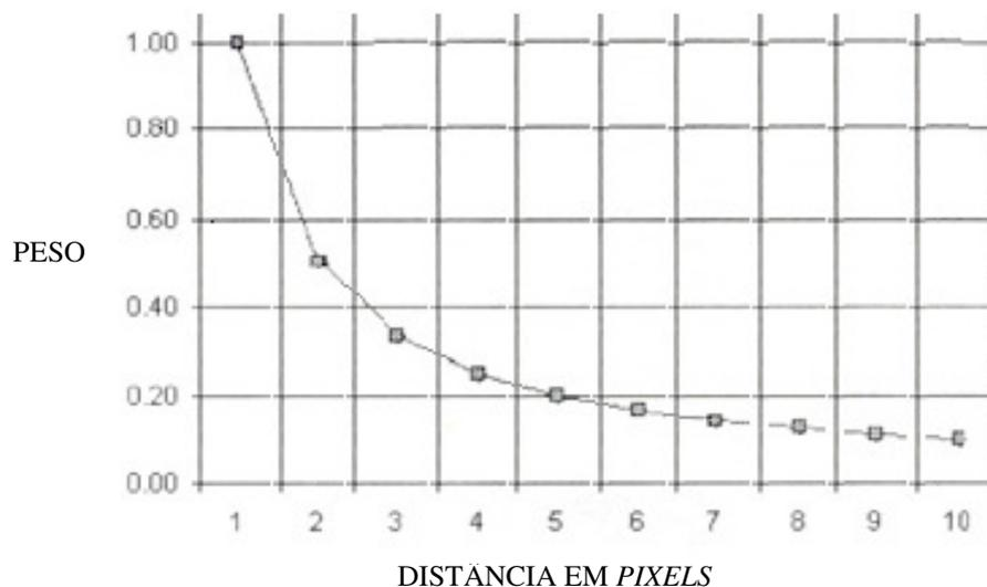
Figura 41: Variação do peso da medida em função da distância ao nó da célula (modificado de CARIS, 2001).
