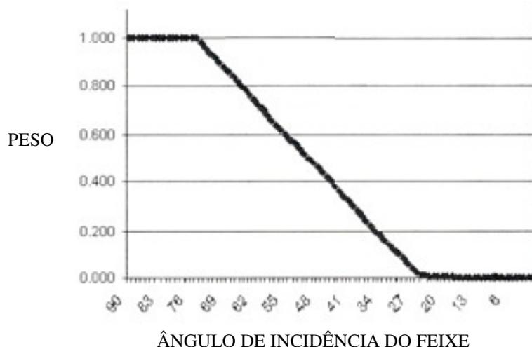
Figura 42: Variação do peso da medida em função do ângulo de incidência do feixe (modificado de CARIS, 2001).
