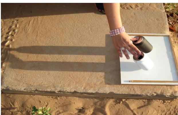
Figura 7. Fotografia de dois calorímetros sendo expostos a radiação solar.
