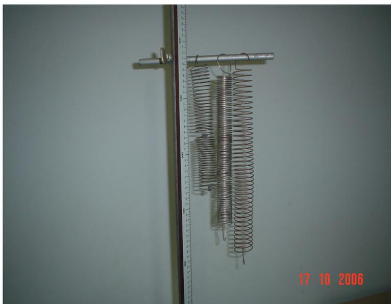
Figura 02 - Fotografia de três molas de diferentes tamanhos espessuras e materiais, penduradas livremente.
