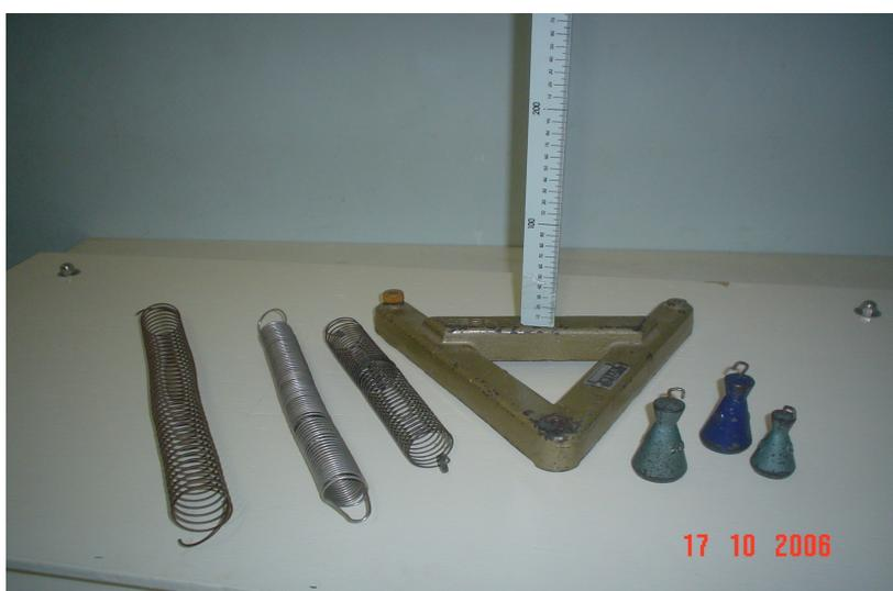
Figura 01 - Fotografia de três molas de diferentes tamanhos espessuras e materiais.
