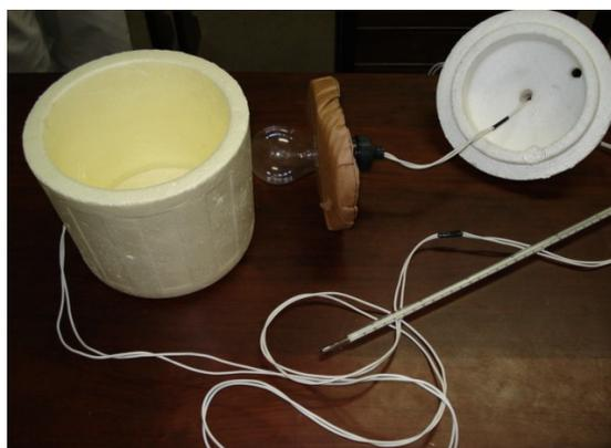
Figura 8. Fotografia da montagem de um calorímetro em que uma lâmpada é colocada em seu interior.
